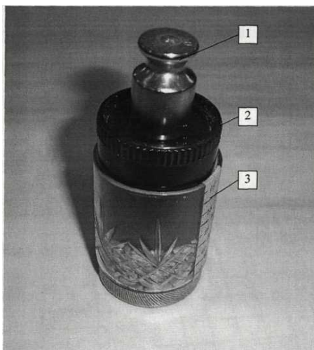
Рисунок 3.2 - Моделювання травмування зерна ковшем норії:
