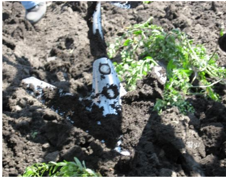
Рисунок 4.10 - Залипання ґрунтом стандартних культиваторних лап
