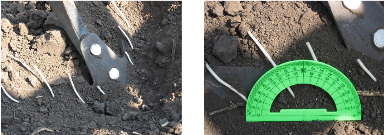
Рисунок 3.5 - Робочий момент визначення кута вступу ґрунту
