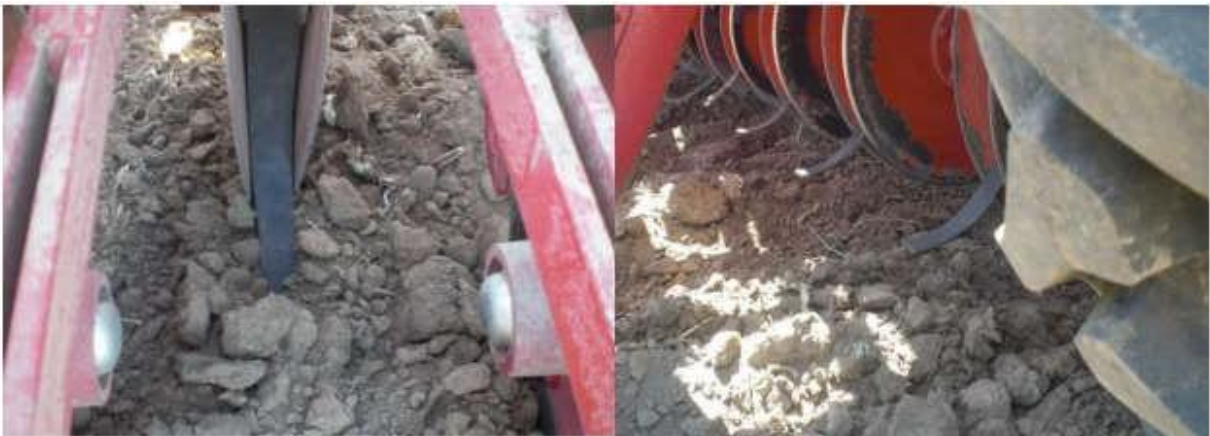
Рисунок - 3.4. Удосконалені сошники зернової сівалки СЗ-3,6
