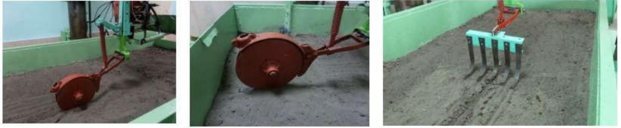
Рисунок - 3.2. Експериментальні робочі органи: а - серійний сошник; б - вдосконалений сошник, в - касета пластин
