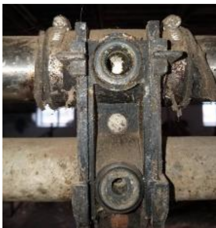
Рисунок 3.9 – Зміщення отвору молочного крана за рахунок зміщення труб
