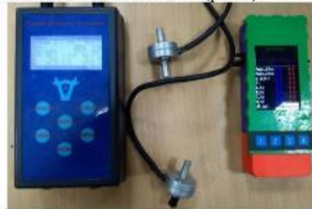
Рис. 1. Загальний вигляд Тестера доїльних установок: а – в. 1.0 і б – в. 2.0
