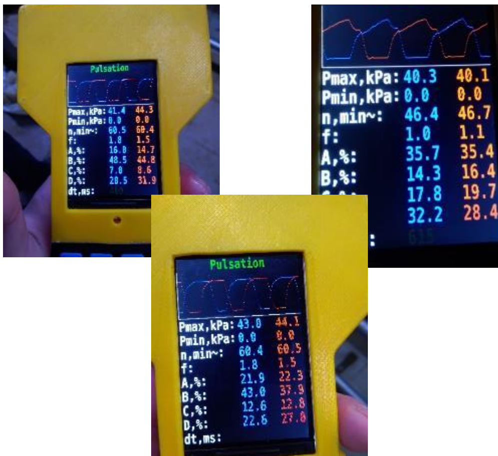
Рисунок 2.3 – Показники співвідношення фаз, частоти тактів та пульсограма пульсатора попарної дії
