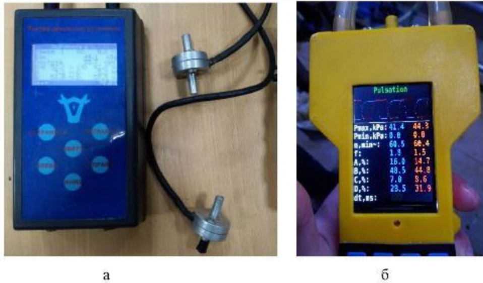
Рисунок 1 – Загальний вигляд Тестера доїльних установок в. 1.0 (а) і в. 2.0 (б)
