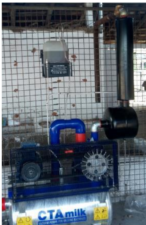
Рисунок 3.8 – Правильно зібрана вакуумна установка фірми «СТА Milk»
