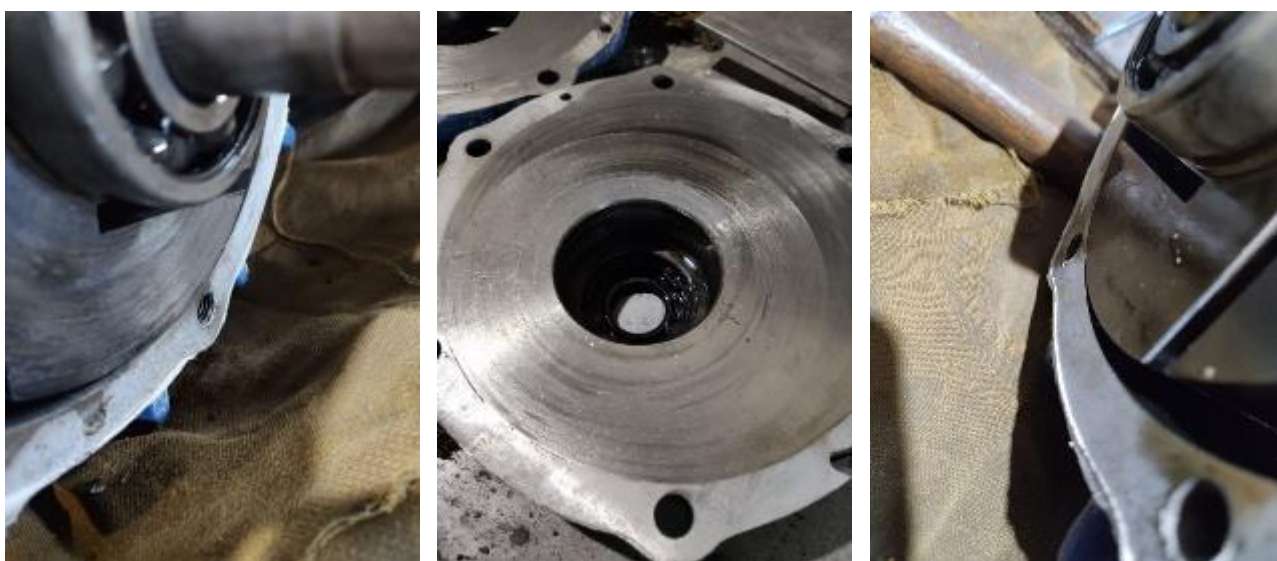
Рисунок 3.5 – Зношені поверхні тертя вакуумного насоса
