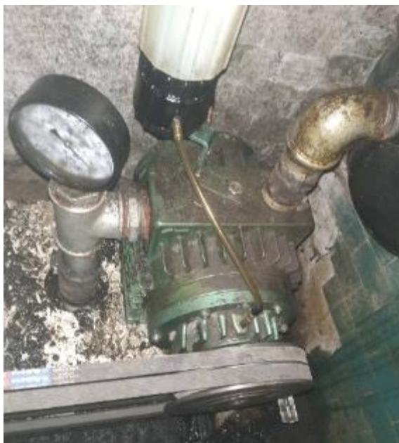
Рисунок 3.3 – Вакуумна установка неправильної комплектації
