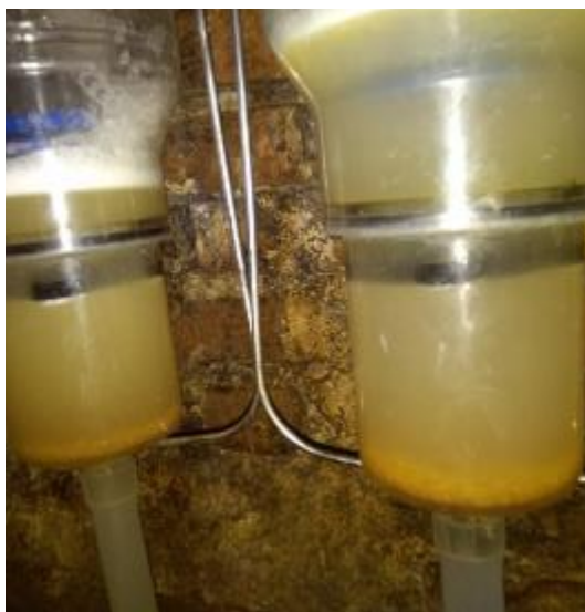
Рисунок 3.11 – Стан води при промиванні каустичною содою
