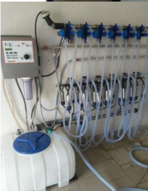
Рисунок 1.4 – Автомати та апарати промивки: а – автомат промивки «Panazoo» (Італія); б – БУАП «Брацлав» (Україна)
