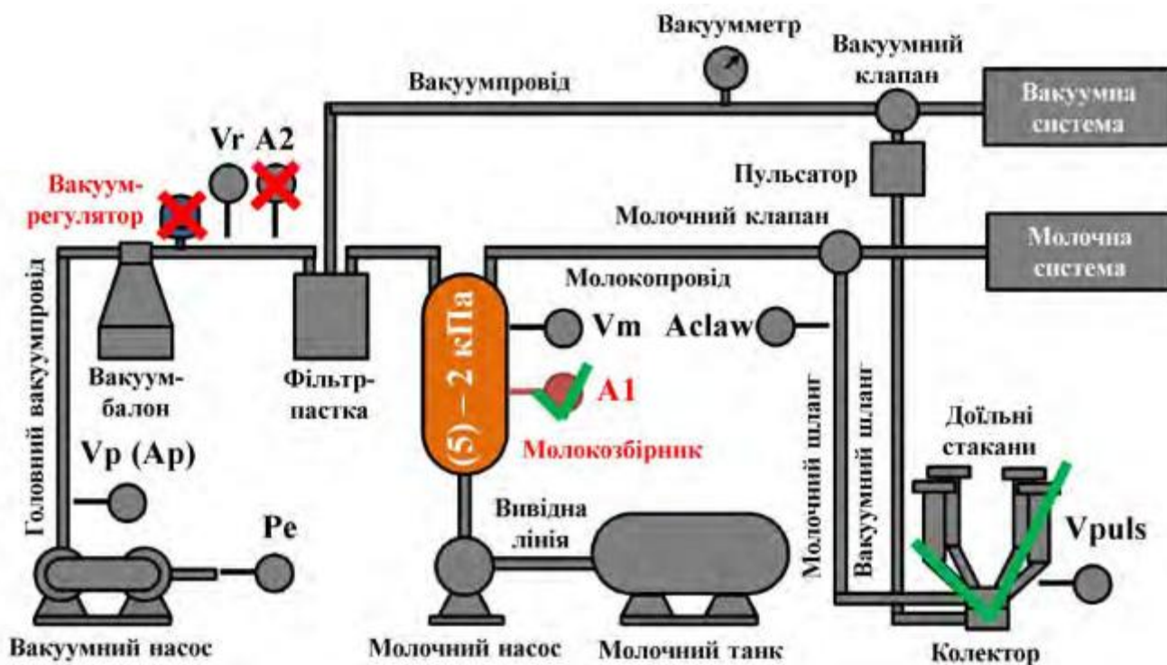
Рисунок 2.25 – Ручний резерв та втрати потоку без вакуум-регулятора
