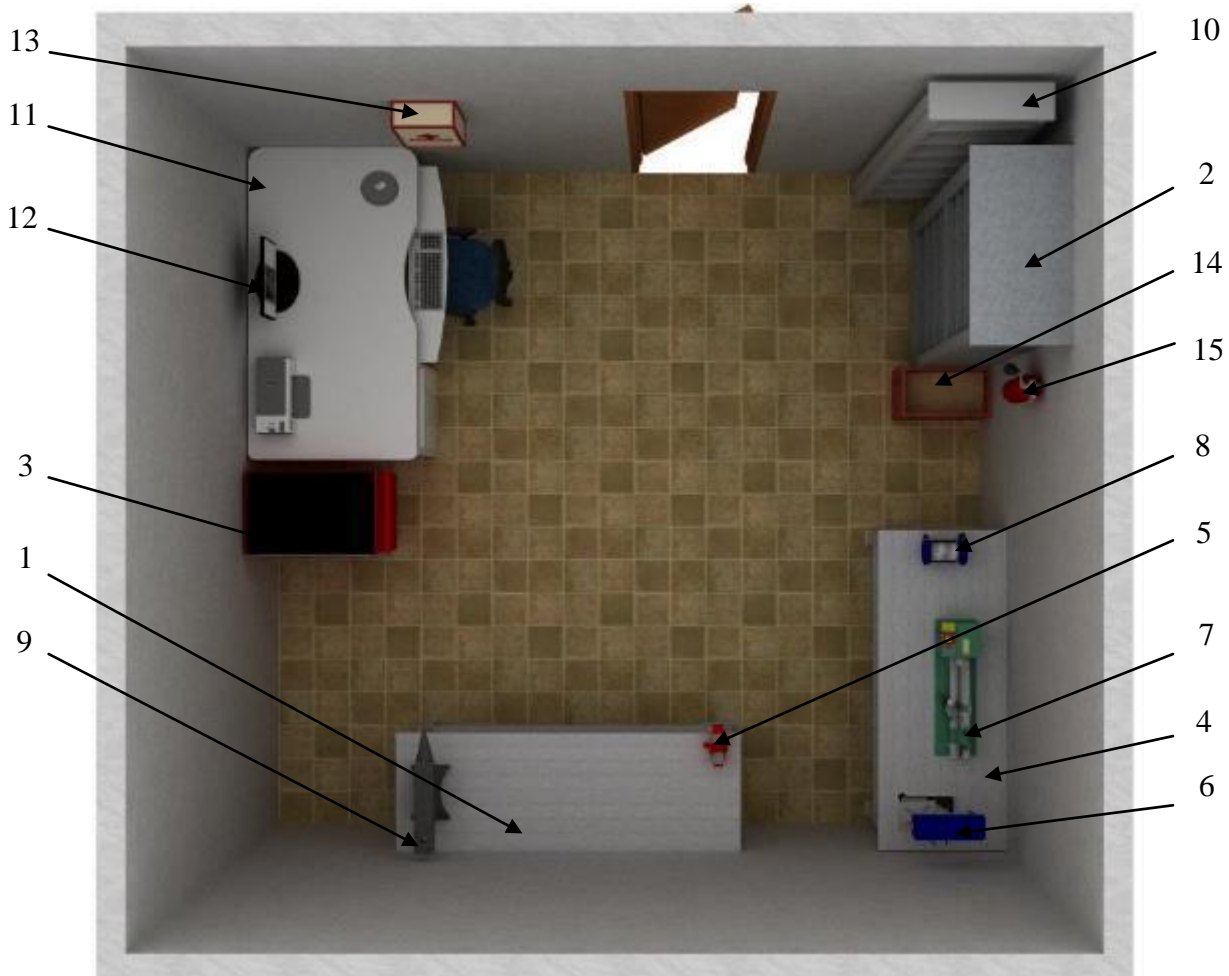
Рисунок 4.1 – Розміщення елементів та обладнання пункту з технічного обслуговування молочно-доїльного обладнання: 1 – слюсарний верстак; 2 – стелаж для зберігання запасних агрегатів та інструментів; 3 – шафа для зберігання інструменту та додаткового устаткування; 4 – металевий робочий стіл для виконання обслуговування; 5 – лещата для слюсарних робіт; 6 – свердлильна установка; 7 – верстат токарний для обробітку металу; 8 – точильно-шліфувальний станок для підгонки запчастин; 9 – ковадло; 10 – драбина або сходи для
