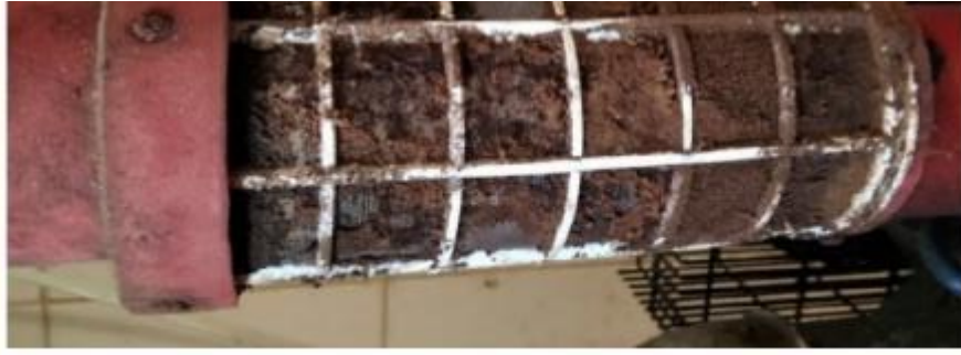
Засмічена фільтр-ресивера вакуумного насоса, яка є причиною пер...
