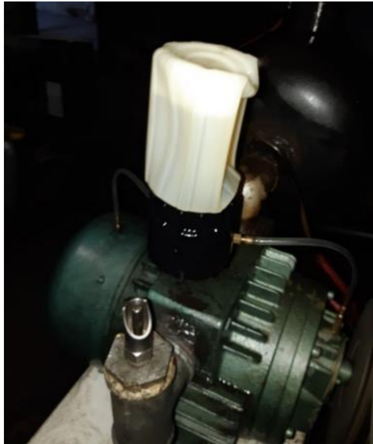
Рисунок 3.2 – Масляна колба вакуумного насоса деформований за рахунок відсутності атмосферного тиску в колбі
