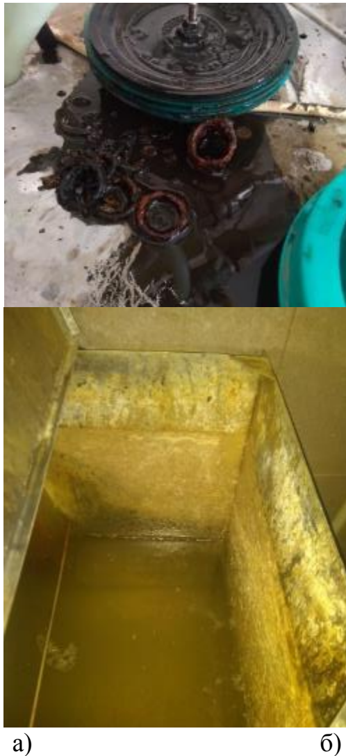
Рисунок 1.5 – Несправності системи промивання доїльних установок: а – вихід з ладу клапана подачі води, б – якість води на фермі яка призводить до відкладень даного характеру
