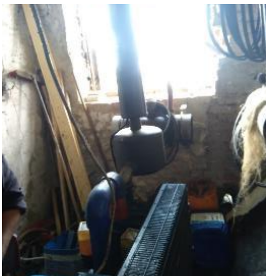
Рисунок 3.7 – Неправильно зібрана система вихлопу
