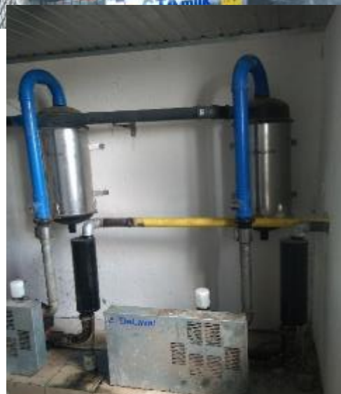
Рисунок 1.1 – Вакуумна установка в зборі: а – фірми «СТА milk» (Італія); б – фірми «DeLaval» (Швеція)
