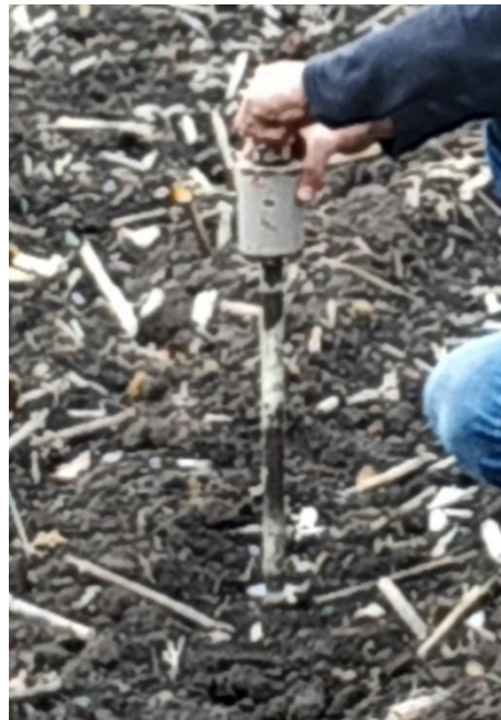
Рисунок 3.5 – Дослідження питомого зчеплення часток ґрунту за допомогою твердоміра ДОРНДІ
