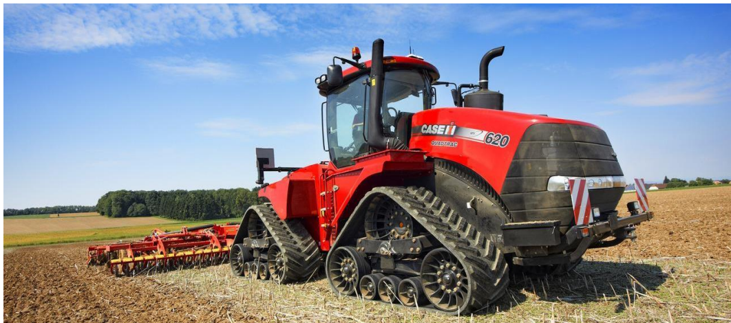
Рисунок 1.3 – Застосування гусеничних рушіїв на тракторах Case «Quadtrac»
