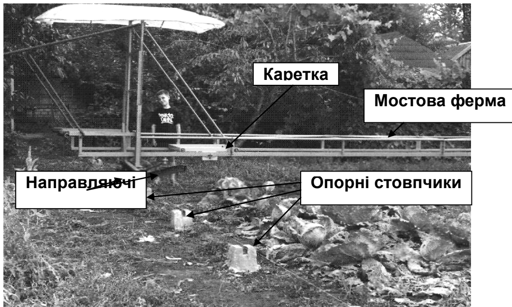
Рис. 1.13. Дослідна установка мостового модуля 2007 рік
