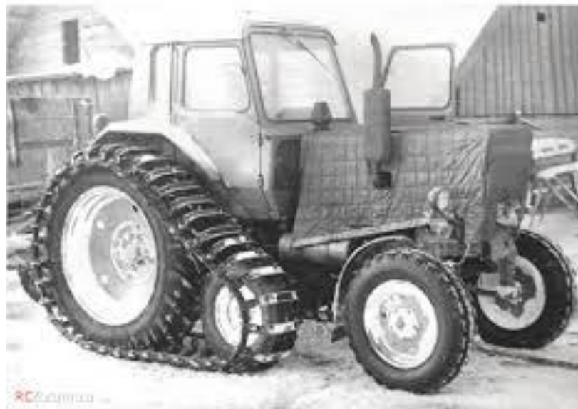
Рисунок 1.2 – Застосування напівгусеничного рушія на тракторах 14 кН
