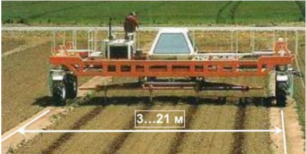
Рисунок 1.8 – Оптимальна довжина прогінної частини мостового трактора
