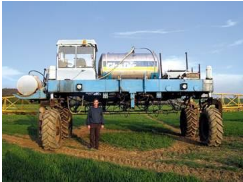
Рисунок 1.9 – Мостовий трактор з шириною прольоту 5,8 метра
