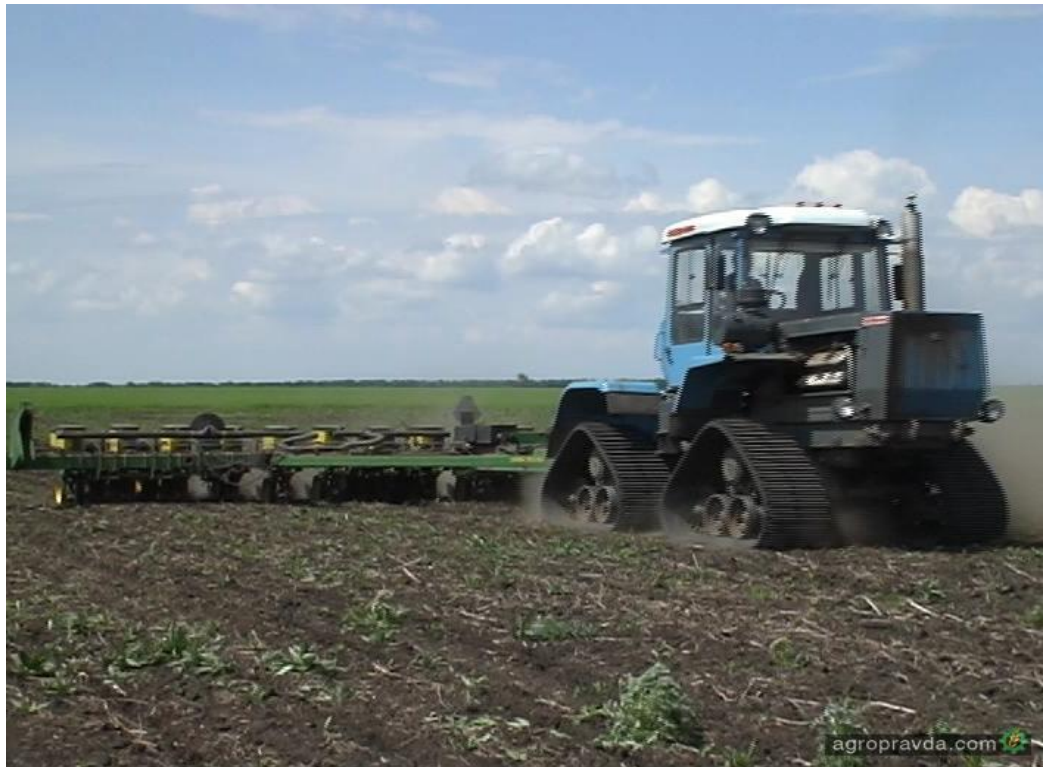
Рисунок 1.4 – Застосування гусеничних рушіїв на тракторах ХТЗ-280
