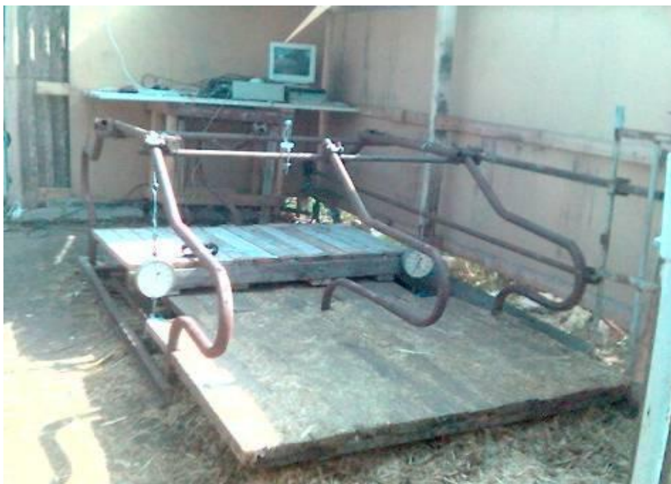
Рисунок 4.4 – Боксове обладнання з комп'ютерним вимірювально-реєструючим комплексом
