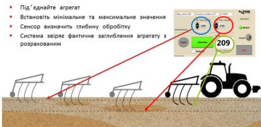
Рис.3.14. Схема налаштування агрегату на диференційований обробіток ґрунту.
