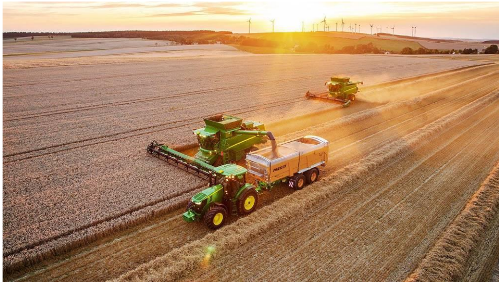
Рис.2.5. Приклад використання системи AMS зі стандартом ISOBUS при вивантаженні зерна з синхронізацією швидкості агрегатів.
