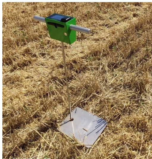
Рис. 2.10. Загальний вигляд цифрового пенетрометра S600, оснащеного GPS GSM антенами.
