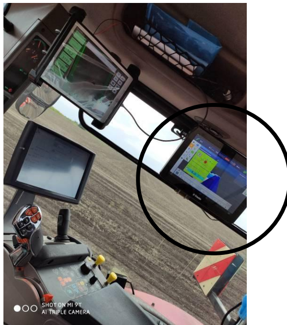
Рис. 2.6. Комплектування трактора CASE IH MX 380 різними моніторами для різних завдань. Поточне завдання, зображене на моніторі Trimble GFX-750 , обведений колом.
