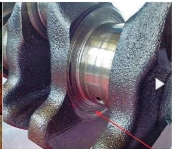
Задир упорної поверхні вала
