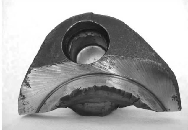
Рис. 1.12. Злам колінчатого вала через множинні втомлювані тріщини в області щоки
