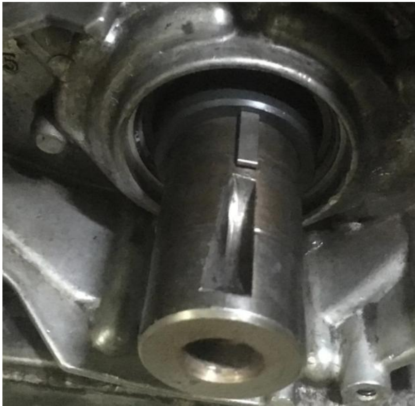
Рис. 1.7. Знос шпонкового пазу
