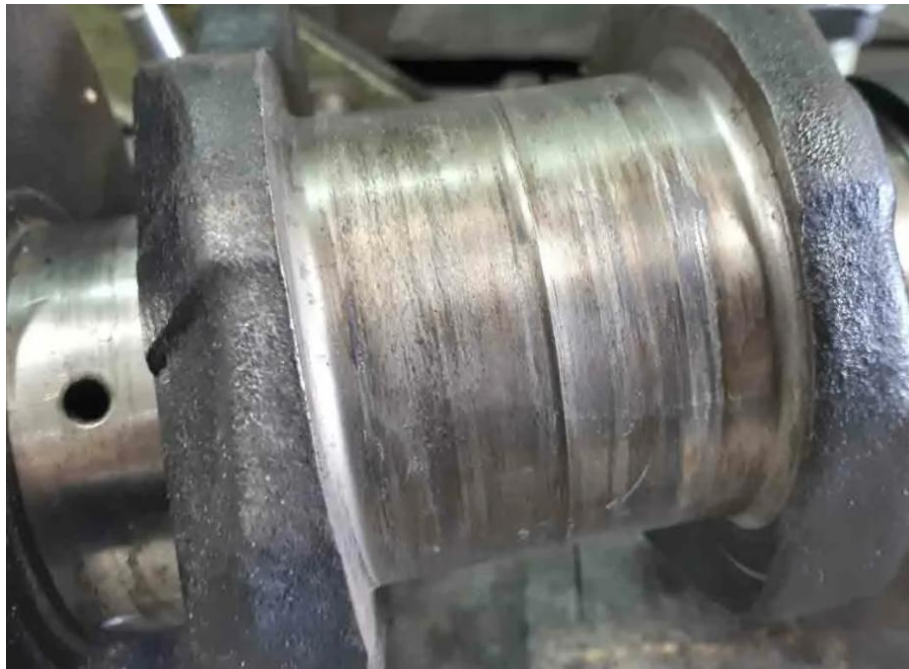
Рис. 1.3. Перезняття бабітового шару вкладишів на шийку валу
