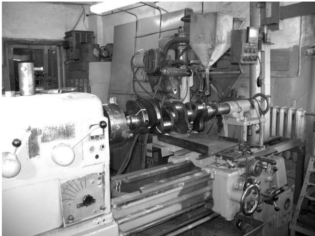
Рис. 3.2 а. Переустаткований токарно-гвинторізний верстат моделі 1К62 з наплавочною головкою А-580М и джерелом живлення дуги ВДУ-506 (загальний вид)
