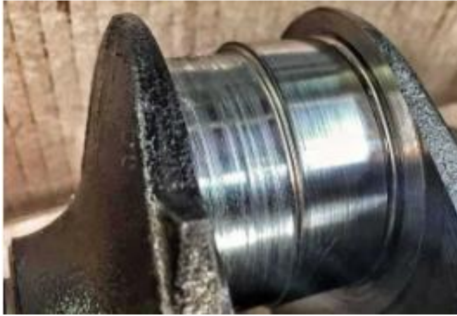
Рис. 1.5. Знос шатунної шийки V подібного двигуна
