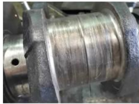
Перезняття бабітового шару вкладишів на шийку валу
