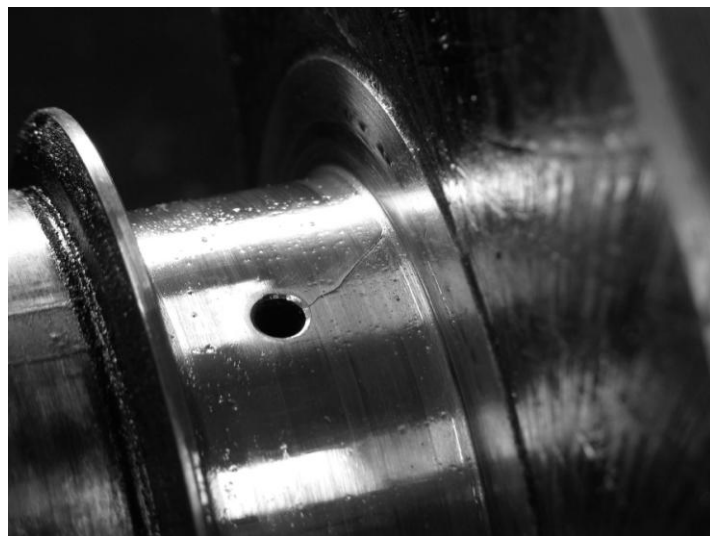
Рис. 1.15. Тріщина в шийці колінчатого вала двигуна КамАЗ-740
