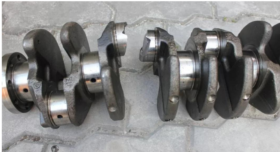
Рис. 1.9. Руйнування колінчатого валу
