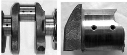
Місця руйнування реальних деталей
