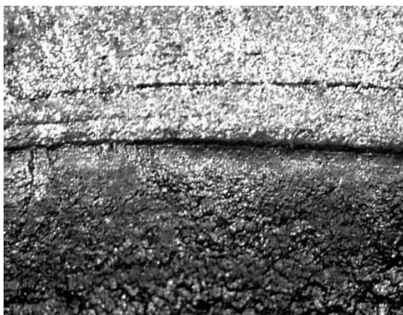
Рис. 2.4. Макроструктура зламу в щоці: перехід із зони розвитку втомленої тріщини в зону тендітного руйнування (50:1)
