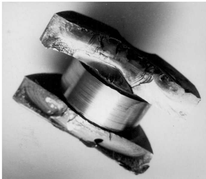
Рис. 1.13. Злам колінчатого вала двигуна «RABA-MAN» по щоках від дії нормальних напружень
