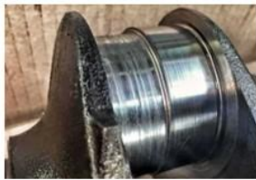
Знос шагунної шийки V подібного двигуна
