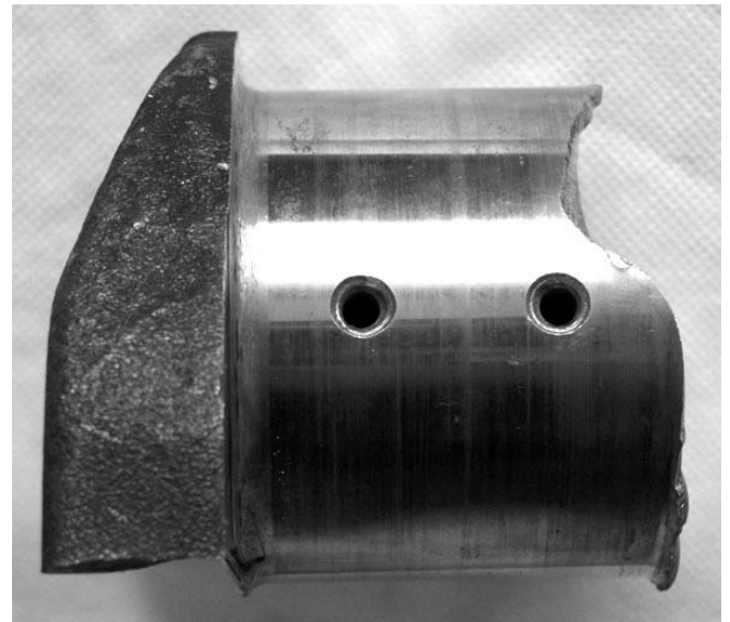
Рис. 2.2. Характер руйнування шийки колінчатого вала в результаті експлуатаційних випробувань
