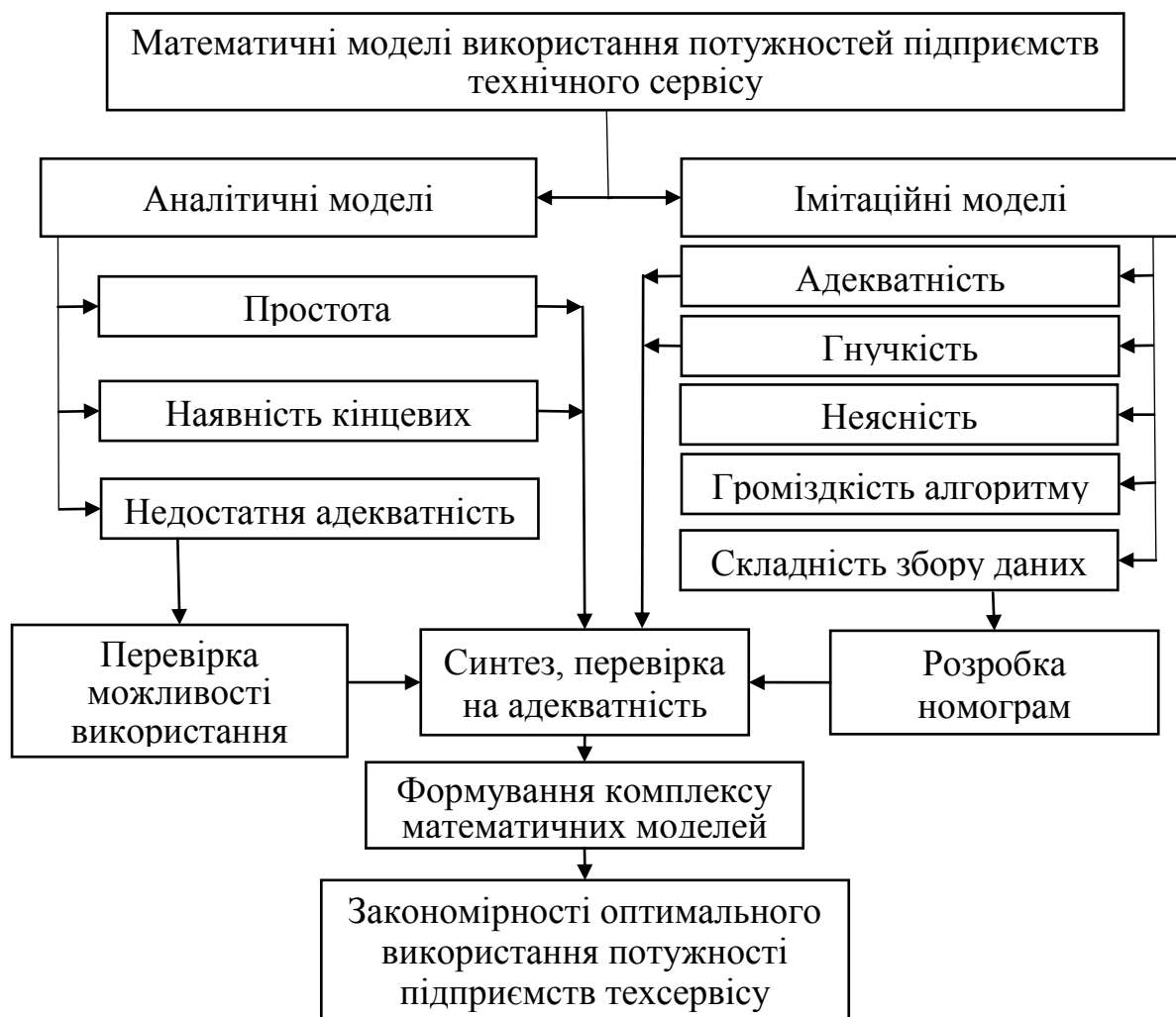
Рис. 1.3. Методологія вибору математичних моделей процесів технічного сервісу
