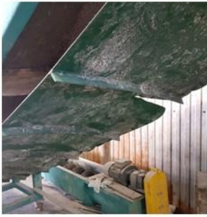
Дефект стрічки (надрив)
