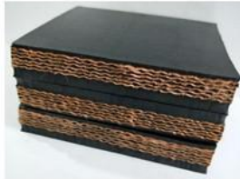
Зразок для визначення опору стиранню гуми
