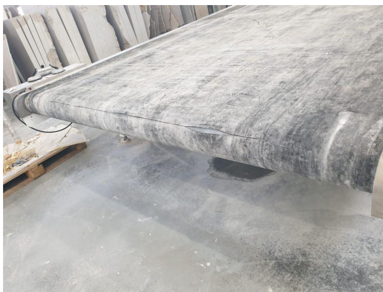
Рис. 1.17. Утворення тріщини та порив стрічки
