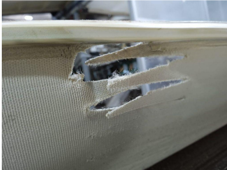
Рис. 1.18. Розшарування стрічки у місцях склеювання
