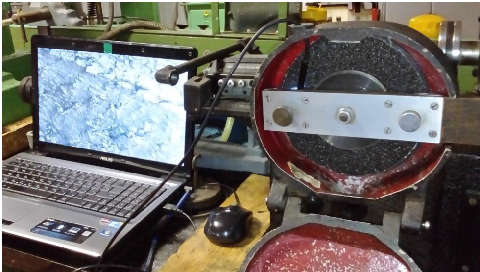
Рис. 3.4. Установка МІ-2 з відео фіксацією процесу стирання
