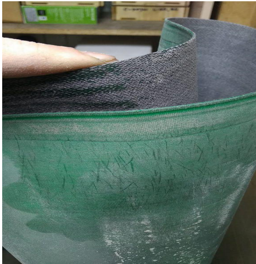
Рис. 1.19. Бічний знос стрічки
