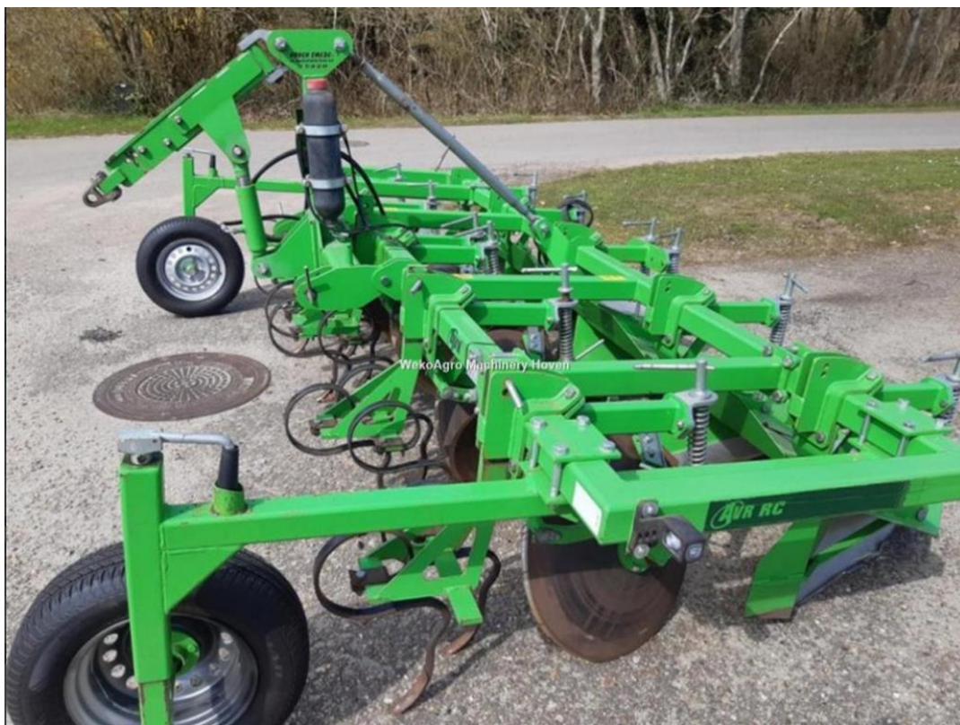
Рис.3.5. Машина для нарізання гребенів AVR Speed Ridger. Агрегатується з тракторами класу 1,4 (на легких ґрунтах) та 2,0 (на середніх ґрунтах).
