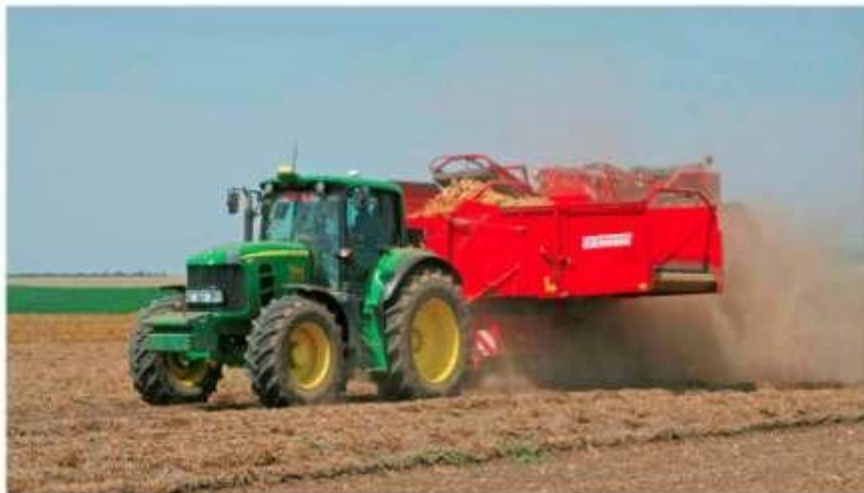
Рис. 1.5. Причіпний картоплекопач BOLKO (концерн UNIA GROUP).
