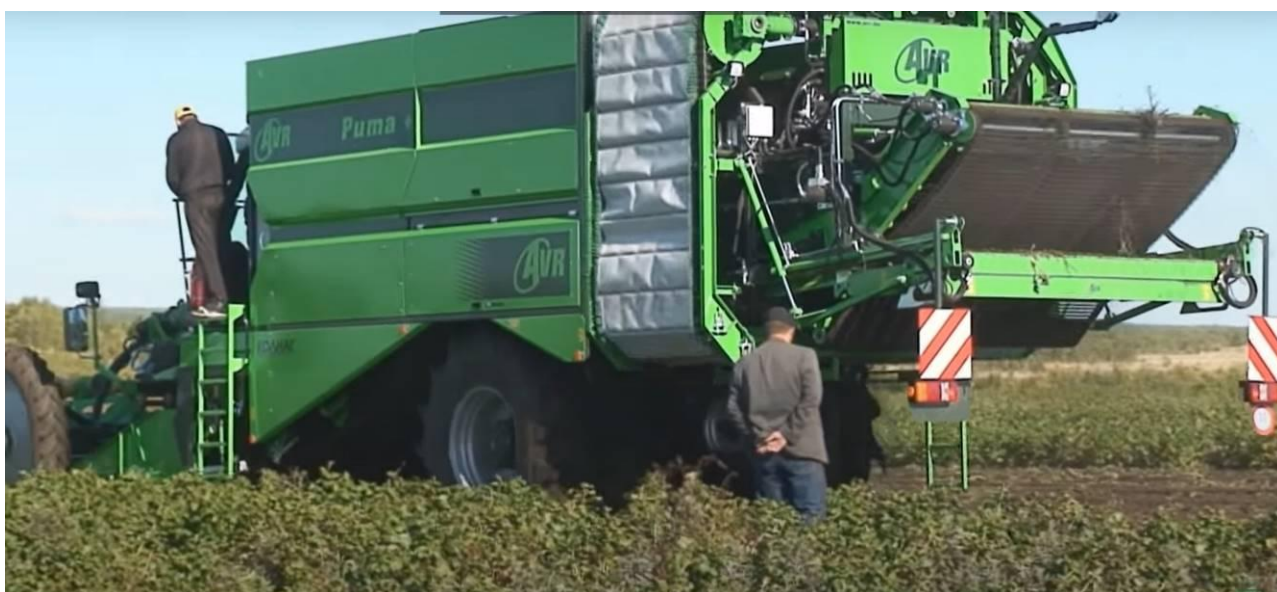
Рис.4.2. Порушення безпеки праці при збиранні картоплі: помічник комбайнера знаходиться на підніжці під час робочого процесу, що заборонено. Також в без-
