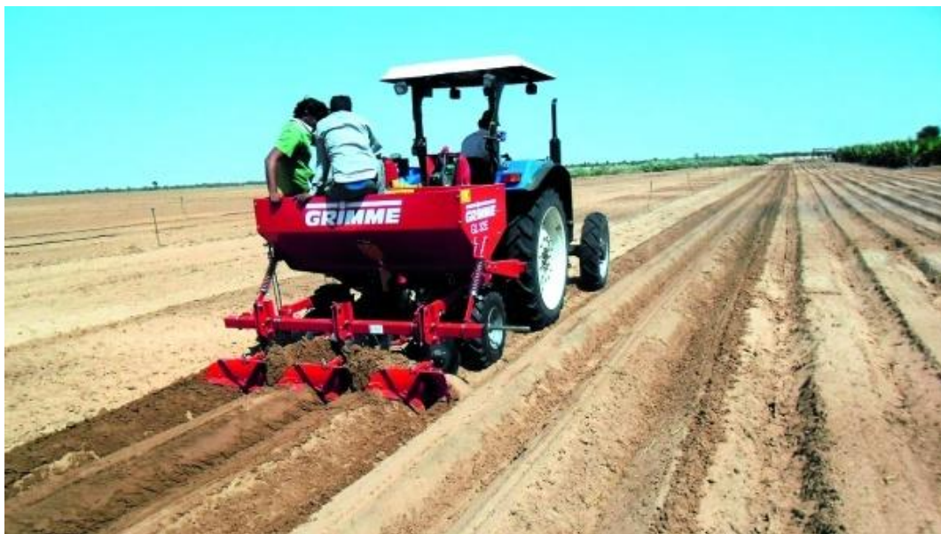
Рис.4.1. Небезпечні зони і фактори садінні картоплі: працівники знаходяться в бункері над робочими органами без захисного одягу, страховок.
