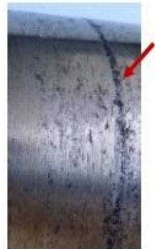
Рис. 1.6 – Корозія робочої поверхні вала в зоні контакту з манжетною
