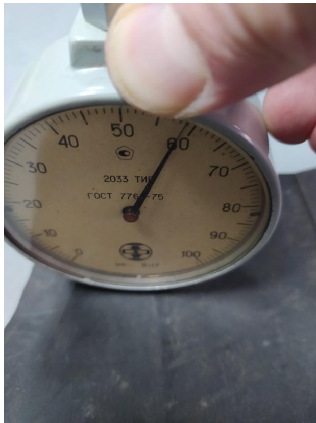
Рис. 3.5. Забір твердості гуми
