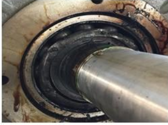
Потрапляння бруду у підшипник внаслідок руйнування манжети
