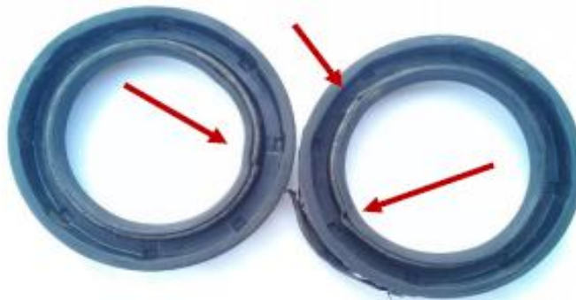
Рис. 1.22 – Порушення форми браслетних пружин
