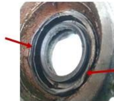
Порушення цілості зовнішньої поверхні манжет
