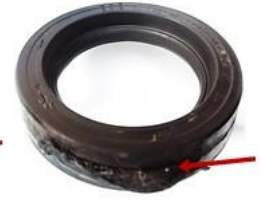
Порушення цілості зовнішньої поверхні манжет
