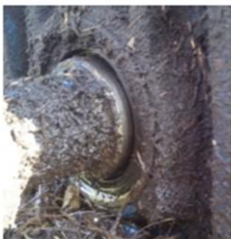
Зовнішній вигляд агрегатів сільськогосподарської техніки при порушенні герметичності ущільнень підшипникових вузлів
