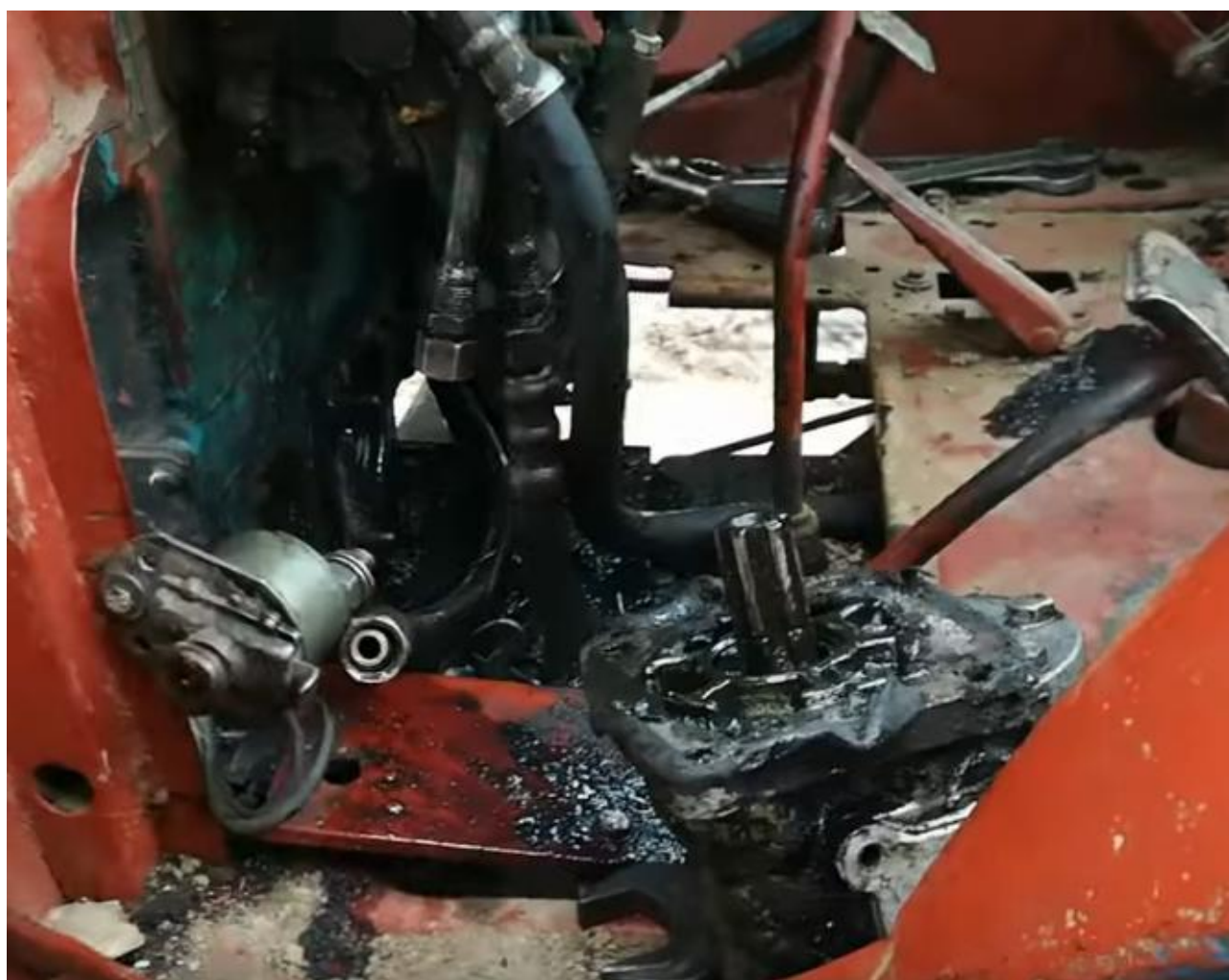
Рис. 1.2 – Зовнішній вигляд агрегатів сільськогосподарської техніки при порушенні герметичності ущільнень підшипникових вузлів
