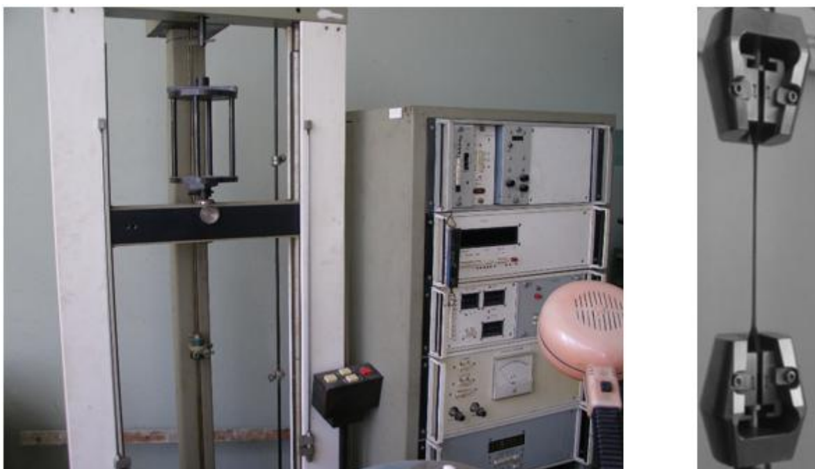
Рис. 3.4. Експериментальна установка 2166 P-5 з розривним вузлом
