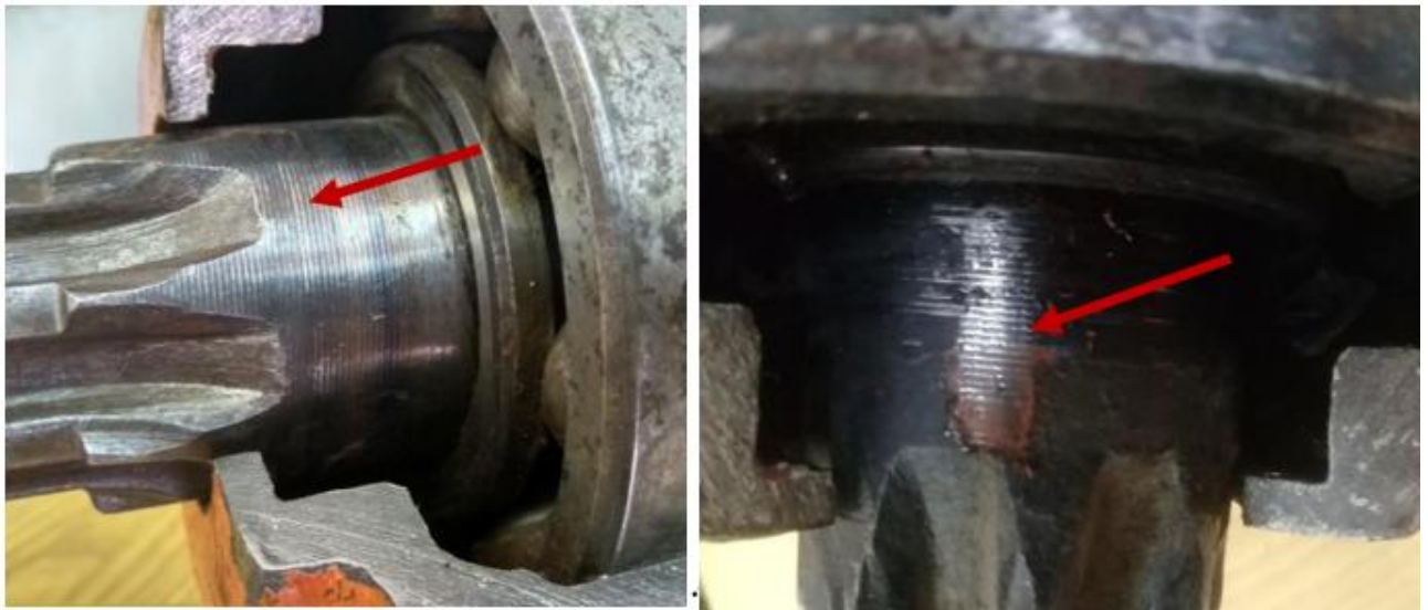
Рис. 1.16 – Неякісна обробка поверхні вала під манжету
