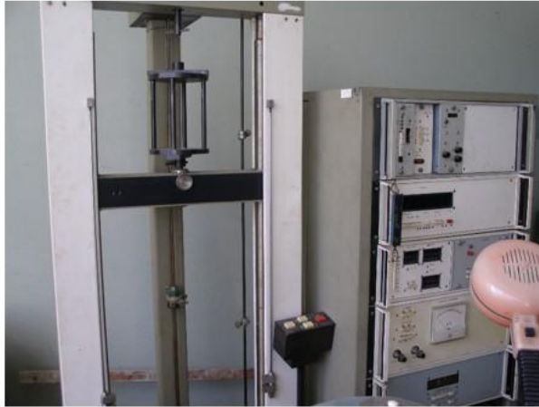
Експериментальна установка 2166 P-5 з розривним вузлом
