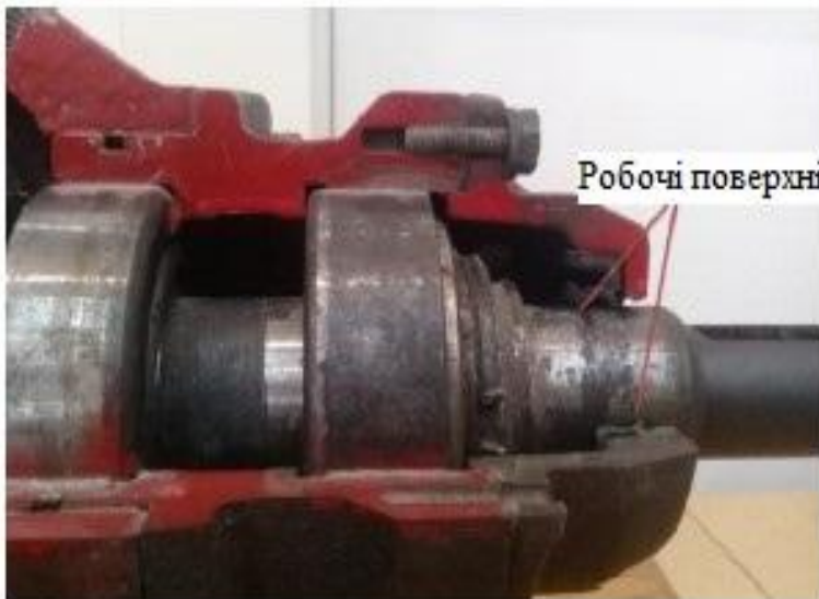
Рис. 1.6 – Корозія робочої поверхні вала в зоні контакту з манжетною
