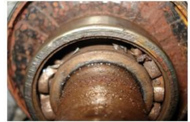
Корозія підшипника внаслідок потрапляння води через зруйнований підшипник
