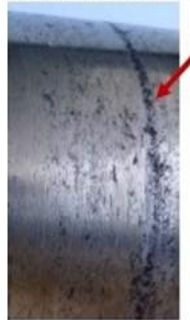
Корозія робочої поверхні вала в зоні контакту з манжетою
