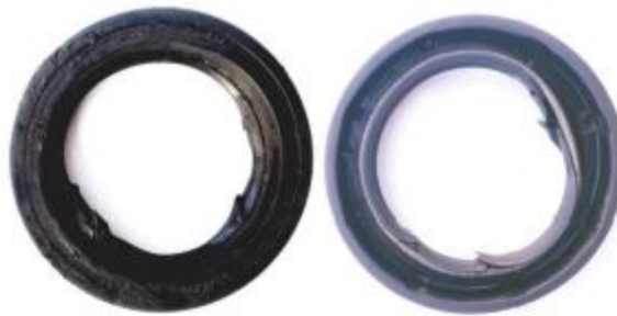
Рис. 1.25 – Ушкодження робочої кромки при монтажі манжети
