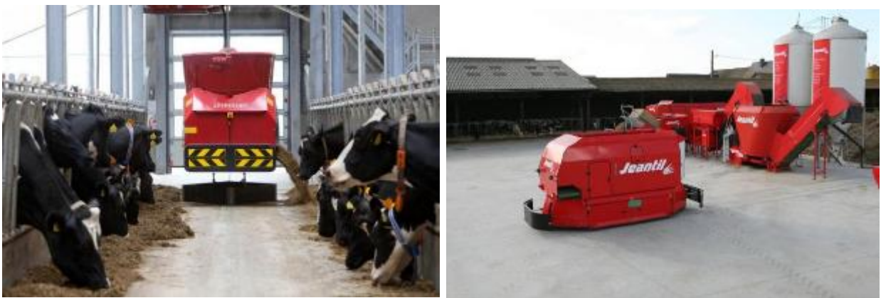
Рисунок 1.10 - Підвісний кормовий візок Triomatic HP 2300 (ліворуч); кормовий візок на шасі Jeantil Automatic Feeding (праворуч)
