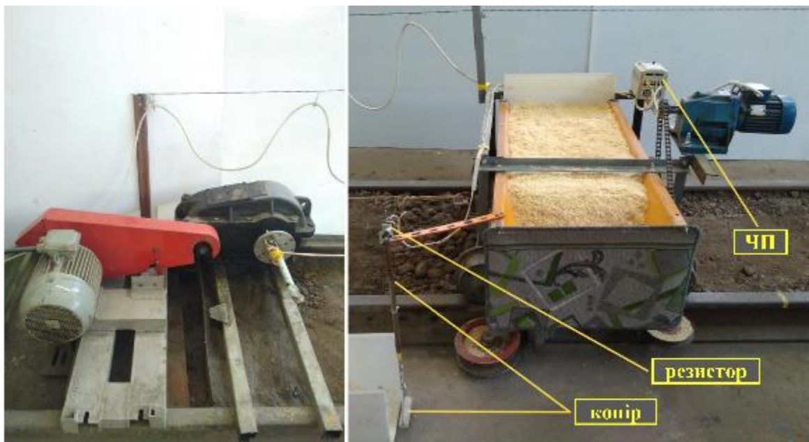
Рисунок 3.1 - Загальний вигляд лабораторної установки системи автоматичної зміни норми видачі кормосуміші кормовим візком: привідна станція (ліворуч) та колійний візок (праворуч)
