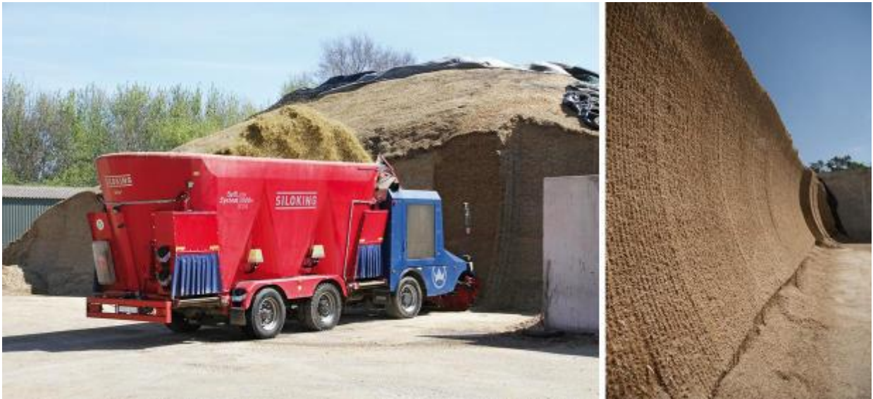
Рисунок 1.3 - Самохідний кормоцех та формований зріз після виїмки кормів із траншеї фрезерним обладнанням
