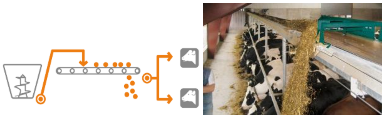
Рисунок 1.8 - Схема роботи (ліворуч) та загальний вигляд автоматичного стрічкового кормороздавача GEA Belt Feeder (праворуч)
