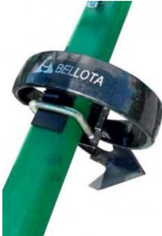
Рисунок 1.5. – Кріплення робочого органу культиватора АК до рами
