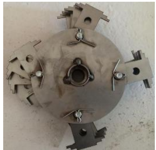
Рисунок 3.2 – Пристрій живлення та загальний вид ротора у зборі
