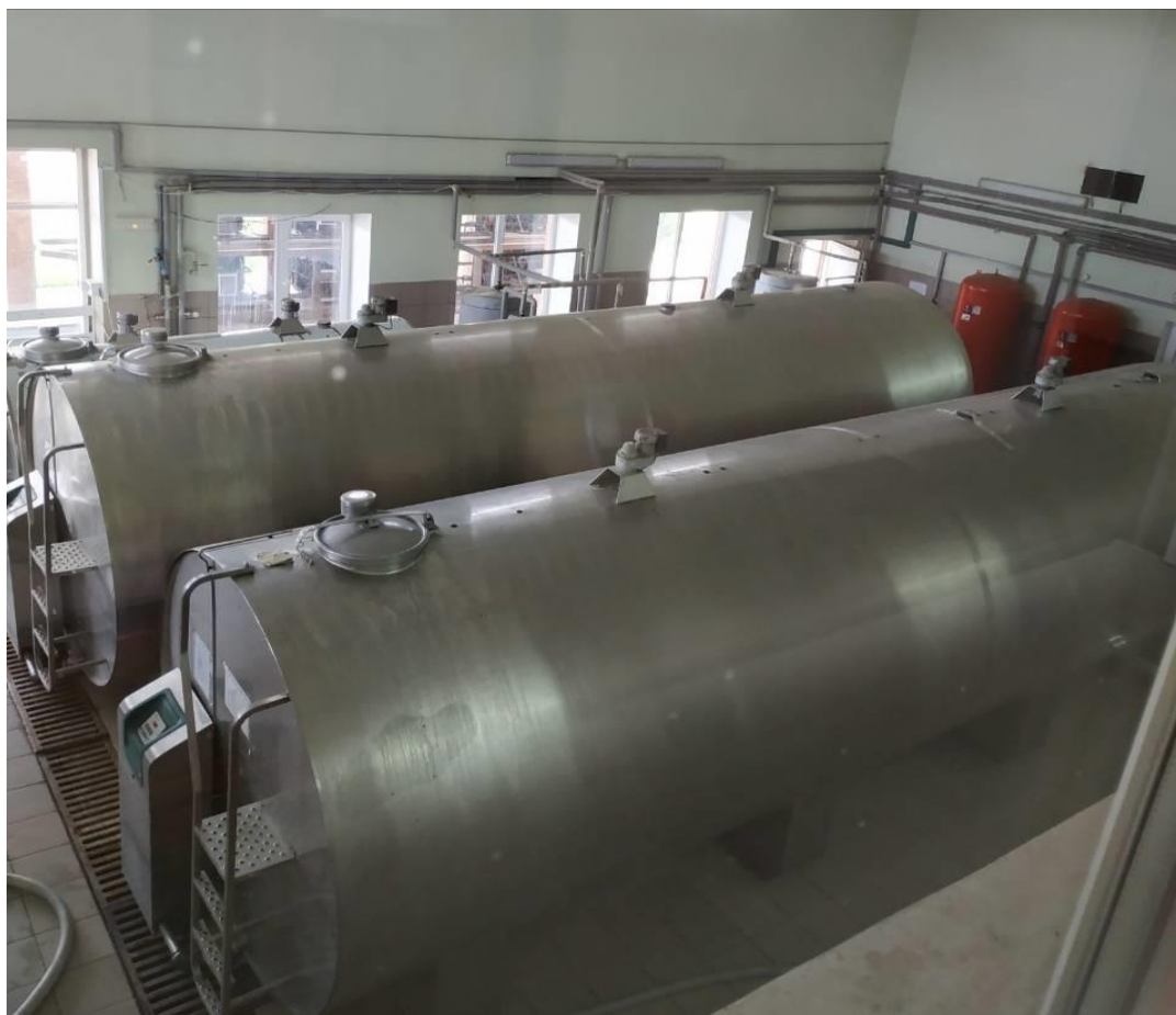
Рис. 20. Танки – охолоджувачі молока «Kryos»
