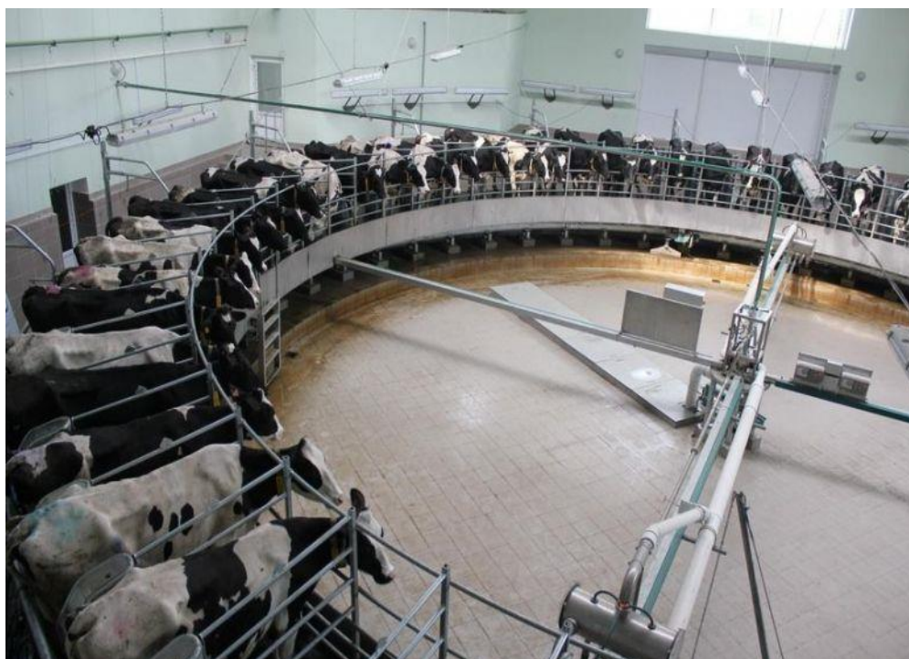
Рис. 17. Доїння корів на установці типу Карусель
