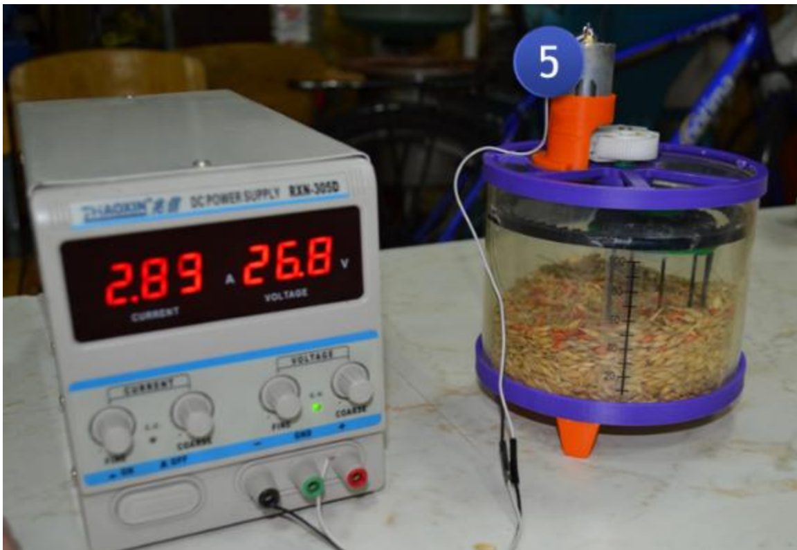
Рисунок 3.1 - Загальний вигляд лабораторної установки: 1-блок живлення, 2-бункер, 3-2-вінцева шестерня, 4-диск зі стержнями, 5 -електродвигун
