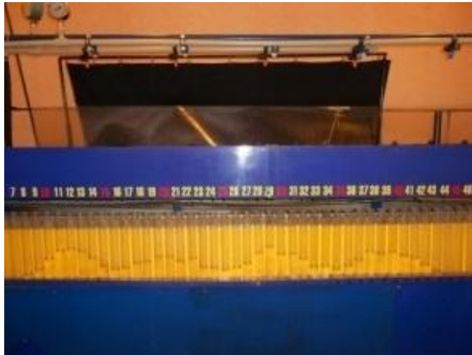
Рис. 4.5. Фото гідравлічного стенду під час дослідження рівномірності розподілу рідини по довжині штанги
