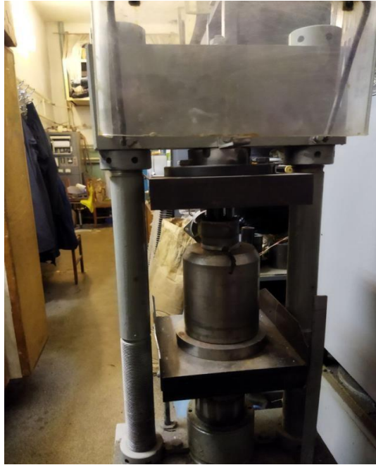
Рис.2.7. Пресування зразків у формі при зусиллі 300\text{кг}/\text{см}^2 .
