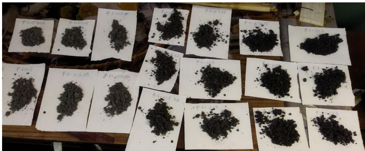
Рис.2.3. Компоненти після змішування в апараті вихрового шару В-150К-02.
