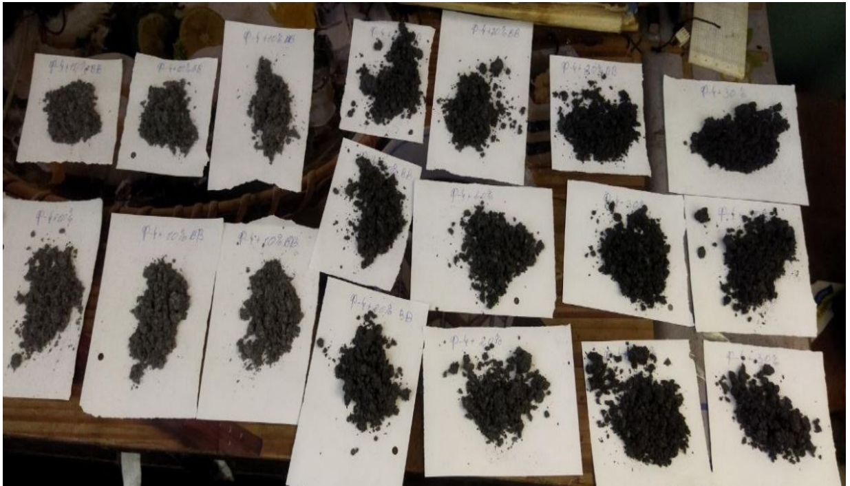
Рис. 2.8 – Компоненти після змішування за допомогою апарату вихрового шару В-150К-02
