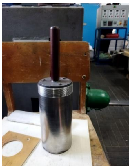
Рис. 2.7 – Колба для змішування компонентів із нержавіючої сталі
