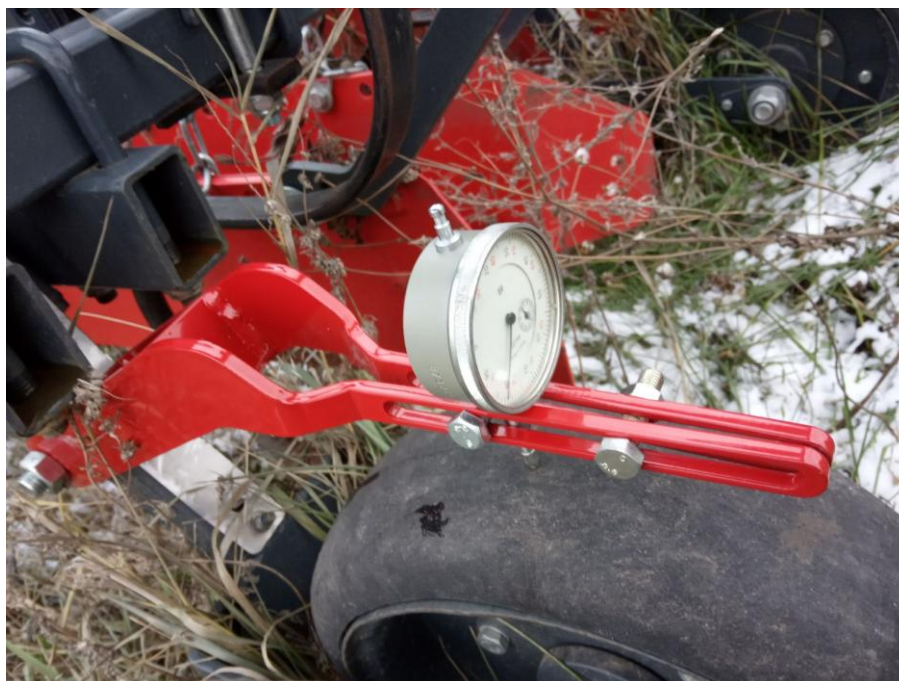
Рис. 3.2. Пристосування для вимірювання радіального зазору котка
