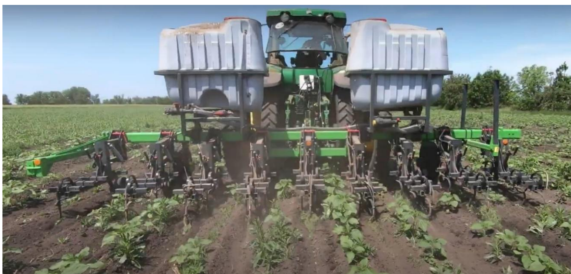
Рис. 3.1. Випробування стійкості ходу лап просапного культиватора
