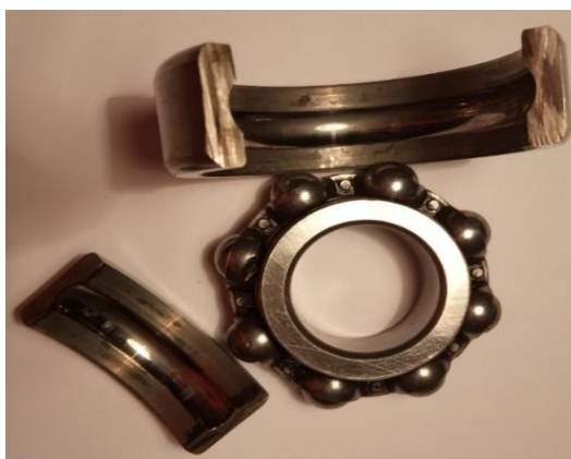
Рис. 3.10. Радіальний шарико-підшипник відкритого типу, зношений, робочі поверхні
