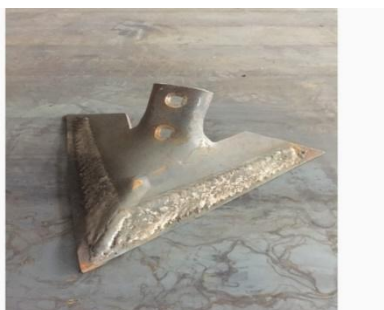
Рис.2.9. Аналітично обґрунтована і прийнята до експериментальних досліджень стрільчаста лапа (варіант№1)
