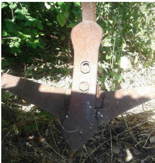
Рис.2.10. – Прийнята до експериментальних досліджень стрільчаста лапа (варіант №2)
