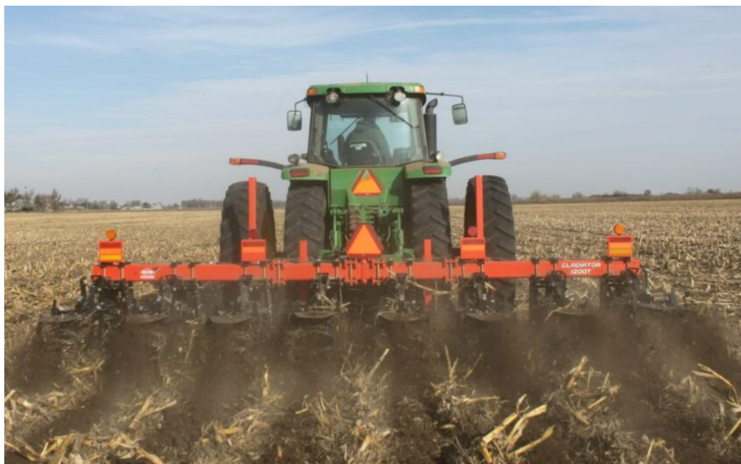
Рисунок 2.3 – Смуговий обробіток ґрунту, агрофон – стерня після кукурудзи (фото взято з [5])
