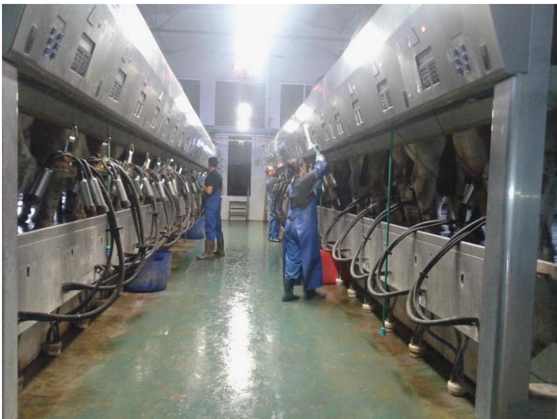
Рис. 16. Доїльна зала у Паралель на 40 доїльних місць
