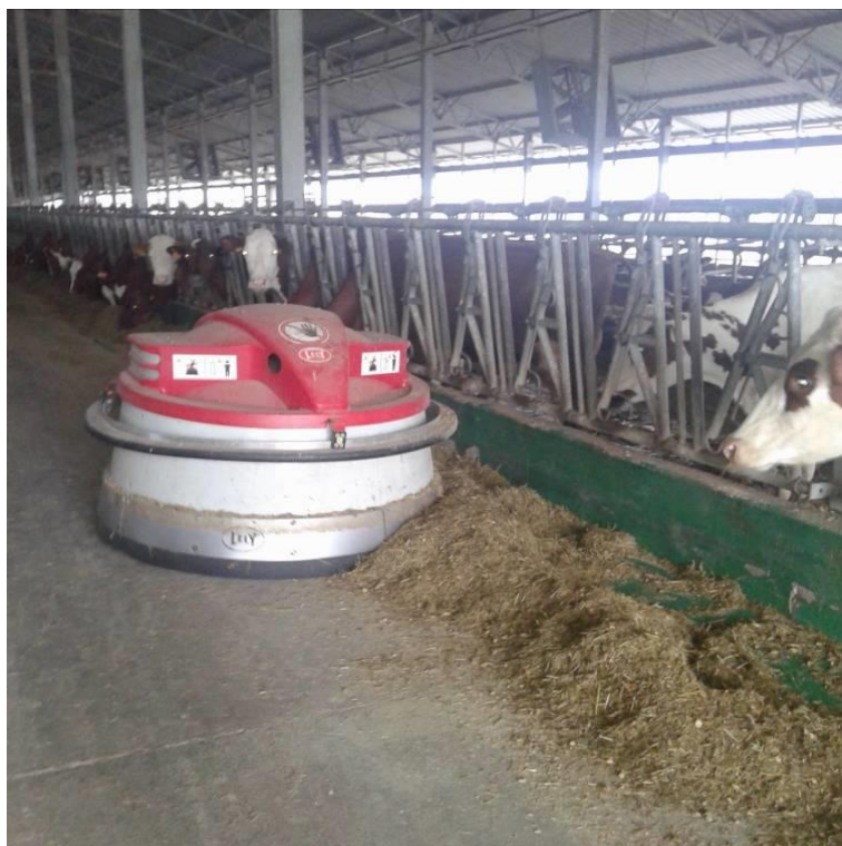
Рис 13. Робот - підштовхувач кормів фірми LELY
