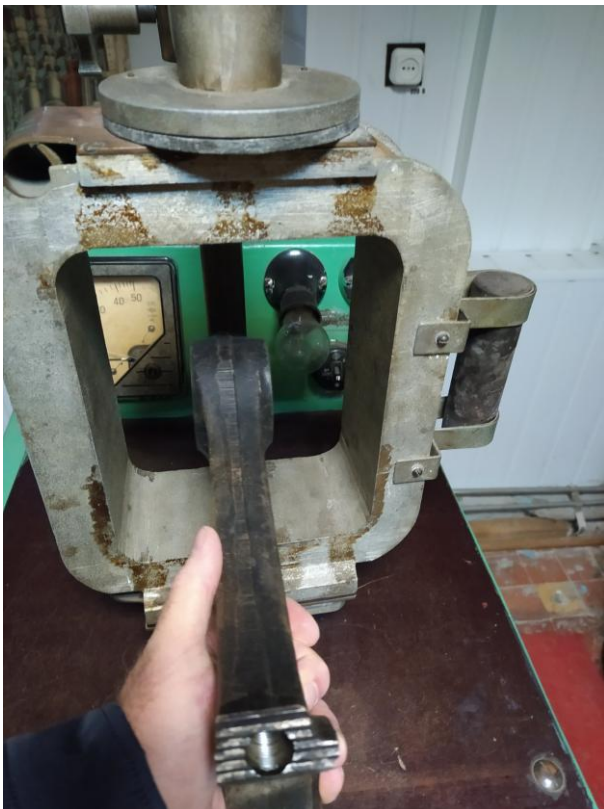
Рис. 3.6. Процес намагнічування деталі в полі силуноїда
