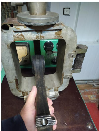
Рис. 3.3 Прилад для намагнічування шатуна(а):
