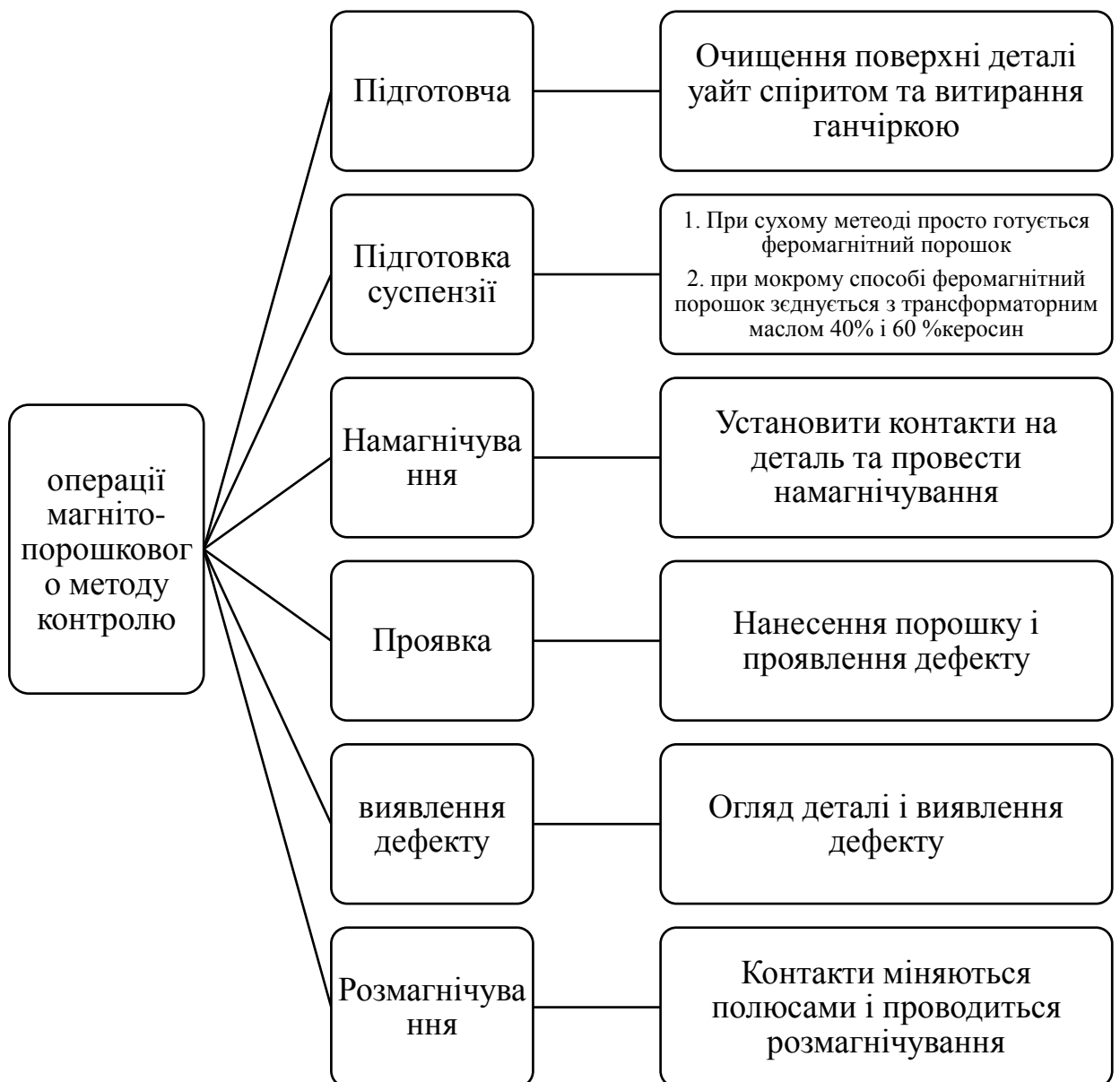
Рис. 3.2. Етапи магніто-порошкового контролю
