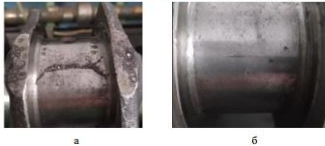
Рисунок 1. Результати виявлення мікротріщин
