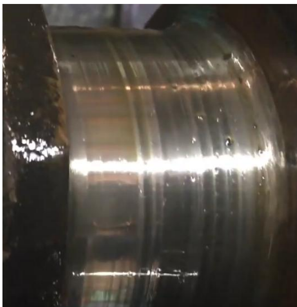
Рис. 3.13. Намагнічування на змінному струмі по мокрому
