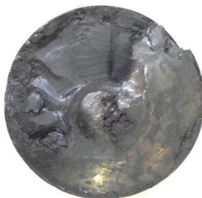
Рис. 1.17. Внутрішній дефект у чистовій осі, виявлений ультразвуковим методом
