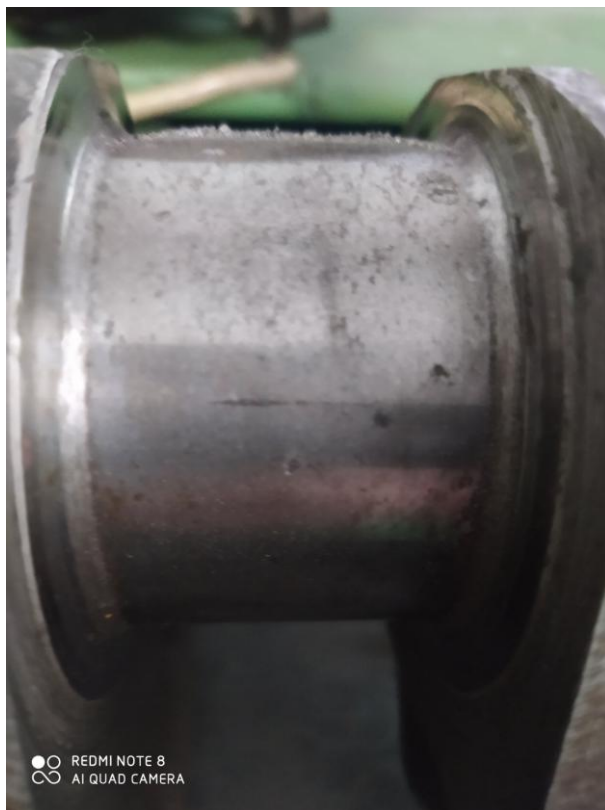
Рис. 3.12. Намагнічування на постійному струмі по сухому
