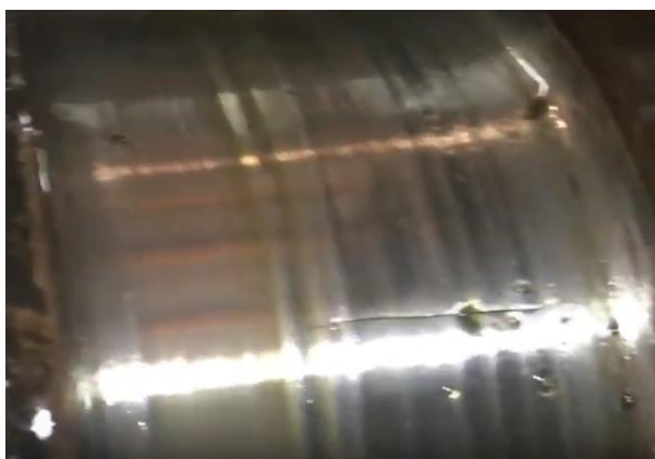
Рис. 3.14. Намагнічування на постійному струмі по мокрому
