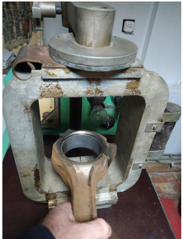
Рис. 3.6. Процес намагнічування деталі в полі силуноїда
