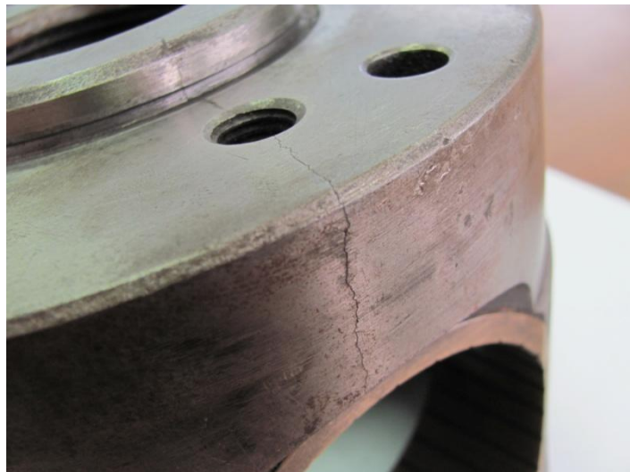
Рис. 1.15. Тріщина на поршневій вставці дизеля 10Д100
