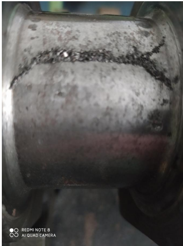
Рис. 3.11. Намагнічування на змінному струмі по сухому Процес виявляє тріщини які не глибокі і досить великі, тріщини що за- лягають на глибині не помічено.
