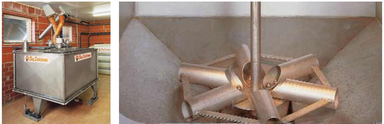
Рисунок 1.8 - Змішувач, яким укомплектовано систему Hydromix фірми Big Dutchman та його мішалка
