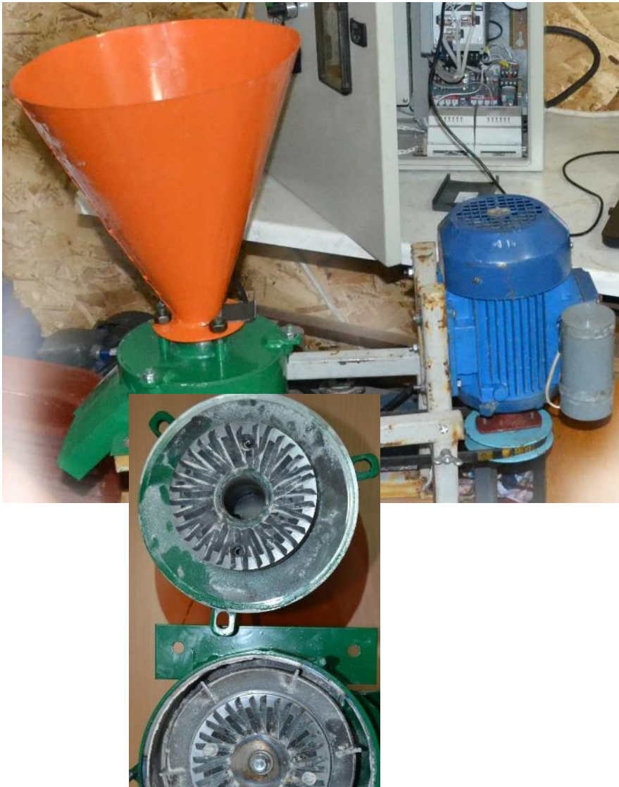
Рисунок 1.5 – Малогабаритний дисковий подрібнювач зерна
