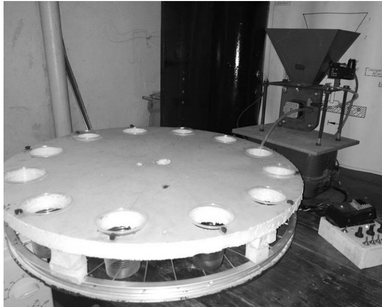
Рисунок 3.12 – Загальний вигляд лабораторного стенду дослідження точності висіву
