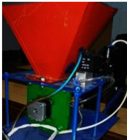
Рисунок 3.2 – Загальний вигляд експериментальної пневмомеханічної сівалки
