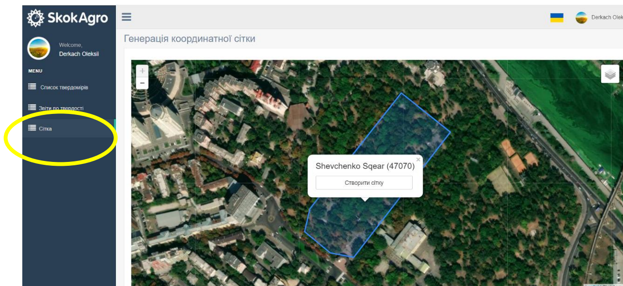
Рис.2.6. Функція «Сітка» дозволяє генерувати точки вимірювань, що рівновіддалені одна від одної.
