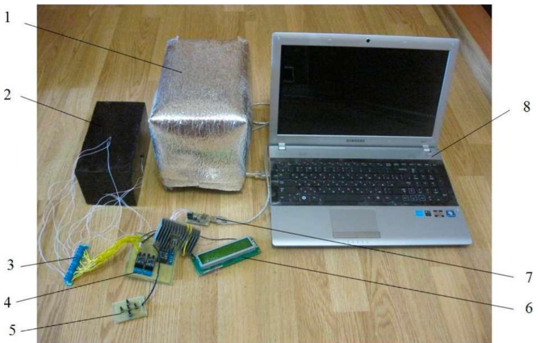
Рис. 3.4. Зовнішній вигляд пристрою контролю температури моделі під тепловим екраном
