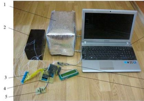
Зовнішній вигляд пристрою контролю температури моделі під тепловим екраном
