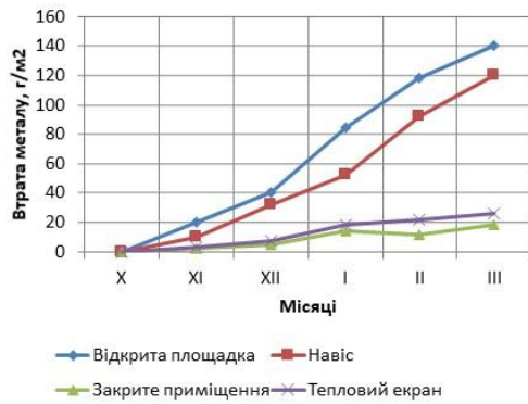
Інтенсивність корозії металу за час зберігання
