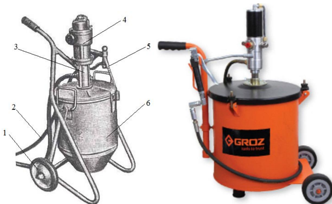
Рис. 2.5 – Загальний вид солідолонагнітача ЦКБ моделі 3154 та його аналог: 1 – візок; 2 – шланг; 3 – насос високого тиску; 4 – пневматичний двигун; 5 – роздавальний пістолет; 6 – резервуар
