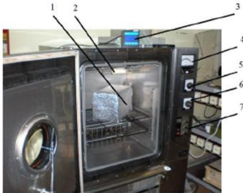
Рис. 3.2. Зовнішній вигляд камери з експериментальним зразком 1- об'єкт зберігання під тепловим екраном; 2- ртутна лампа; 3- індикаторне табло; 4- стрілочний термометр; 5- перемикач режимів нагрівання; 6- пере- микач режимів охолодження; 7- пульт керування
