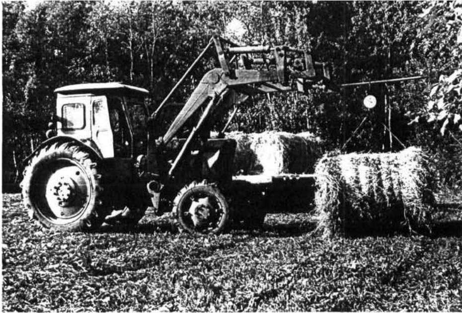
Рис. 3.1 Зважування рулонів хлібної маси за допомогою навантажувача ПКУ-0,8 з пристосуванням ПТ-Ф-500, встановлених на тракторі Т-40АМ.
