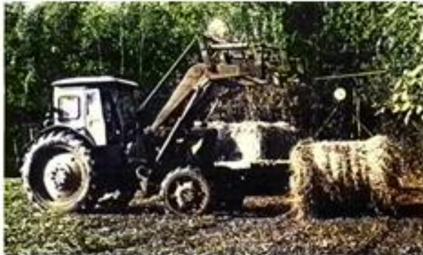
Зважування ролонів хлібної маси за допомогою навантажувача ПКУ-0,8 з пристосуванням ПТ-Ф-500, встановлених на тракторі Т-40АМ
