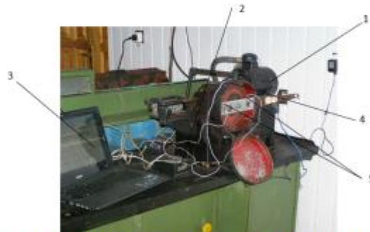
Рис. 1. Загальний вигляд експериментальної установки 1-машина Тертя МІ-2, 2-Перетворювач, 3-ПОМ, 4-індукційний датчик обертів, 5-Термопар.
