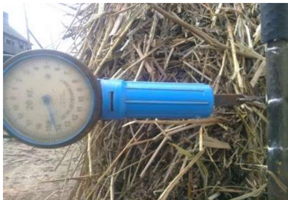
Рисунок 4.11. Вимірювання зусилля оператора на важіль управління відкриттям борту платформи.
