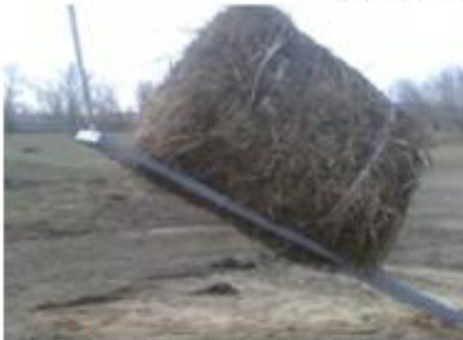
Проведення експерименту з визначення статичного кута тертя
