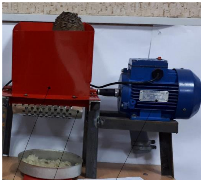
Рисунок 1.8 – Вертикально-дискова малогабаритна коренерізка (б) та горизонтально-барабанна коренетерка (а)
