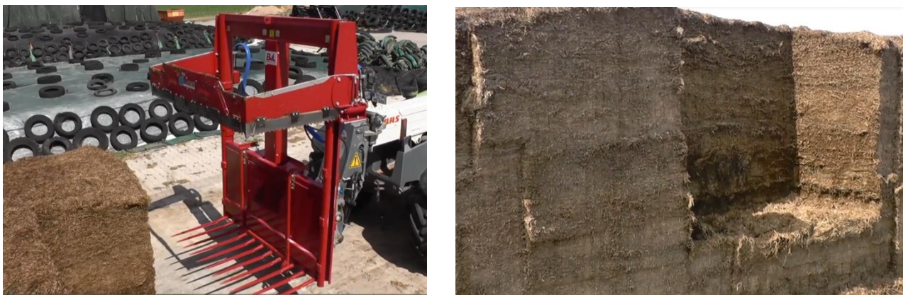
Рисунок 1.2 – Завантажувач силосу періодичної дії з активними ножами VvL V-LOAD Cutter
