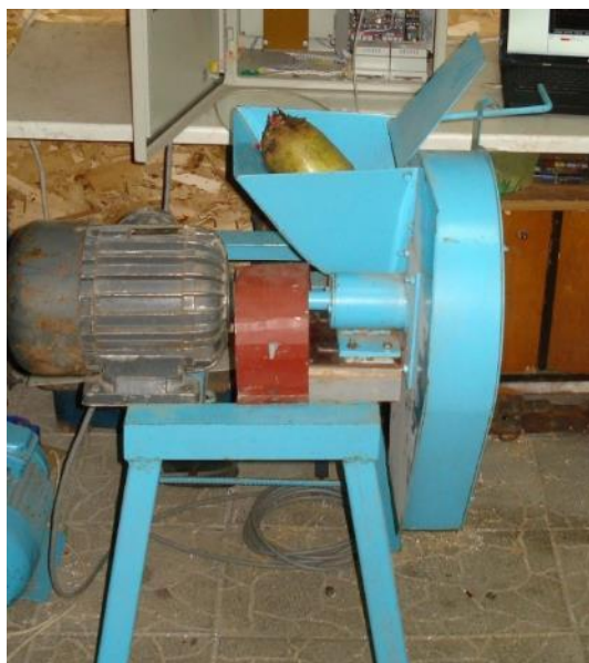
Рисунок 1.8 – Вертикально-дискова малогабаритна коренерізка (б) та горизонтально-барабанна коренетерка (а)
