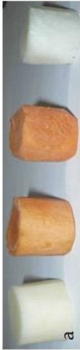
Рисунок 9 – Зразки картоплі, моркви та буряків до руйнування (а), після руйнування (б)
