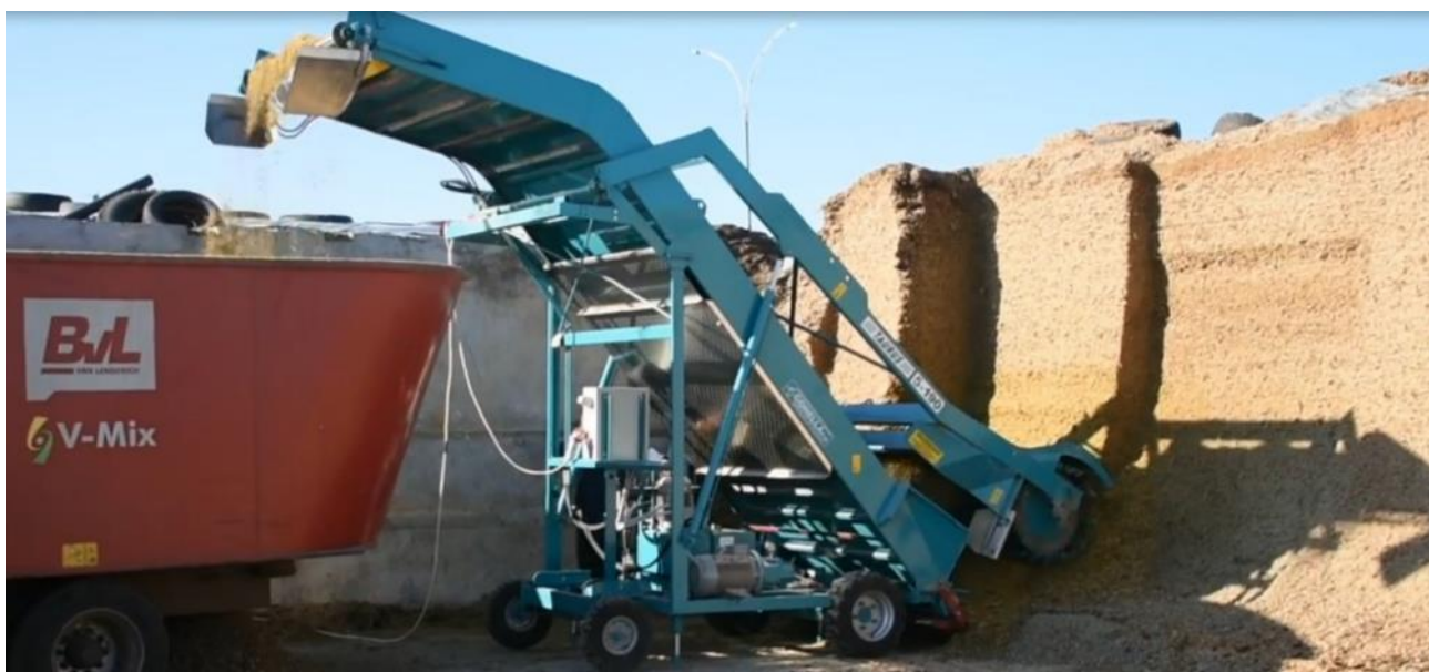
Рисунок 1.4 – Завантажувач силосу поточної дії з роторним подрібнювачем Gonella Taurus 5-190
