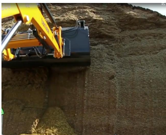
Рисунок 1.3 – Завантажувач силосу періодичної дії з роторним подрібнювачем Tenias
