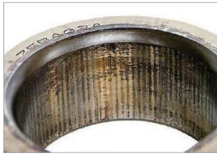
Рис. 1.9 Абразивне зношування. Ушкодження поверхні кочення
