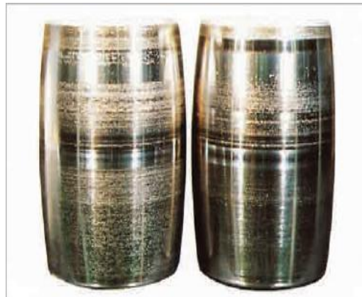
Рис. 1.15. Адгезія на тілах і доріжках кочення через недостатнє змащення.
