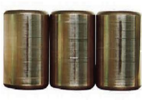
Рис. 1.12. Бринелювання доріжок кочення
