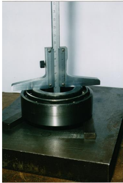
Рис. 3.3. Вимірювання осьового зазору підшипника
