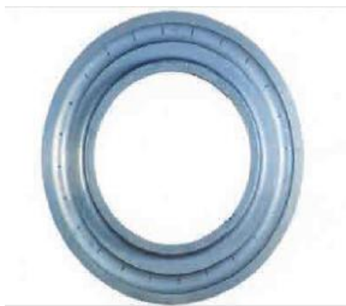
Рис. 1.3. Неправильне бринелювання. Відбитки на доріжці кочення за рахунок передачі монтажного зусилля через тіла кочення
