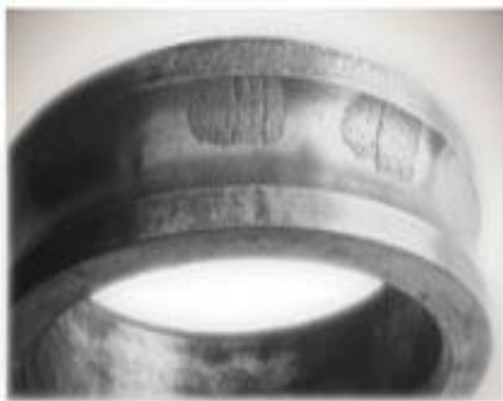
Рис. 1.12. Бринелювання доріжок кочення
