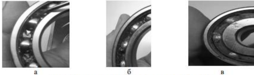
Рис. 2 Заповнення підшипників змазкою Літол 24
