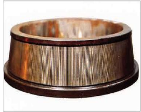
Рис. 1.14. Піттинг поверхні доріжок кочення через проходження сильного струму. Кратери на кульках викликані електрострумом.
