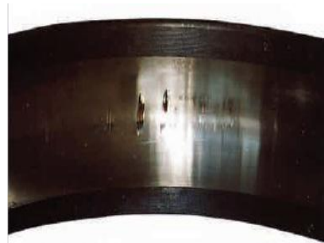
Рис. 1.12. Бринелювання доріжок кочення
