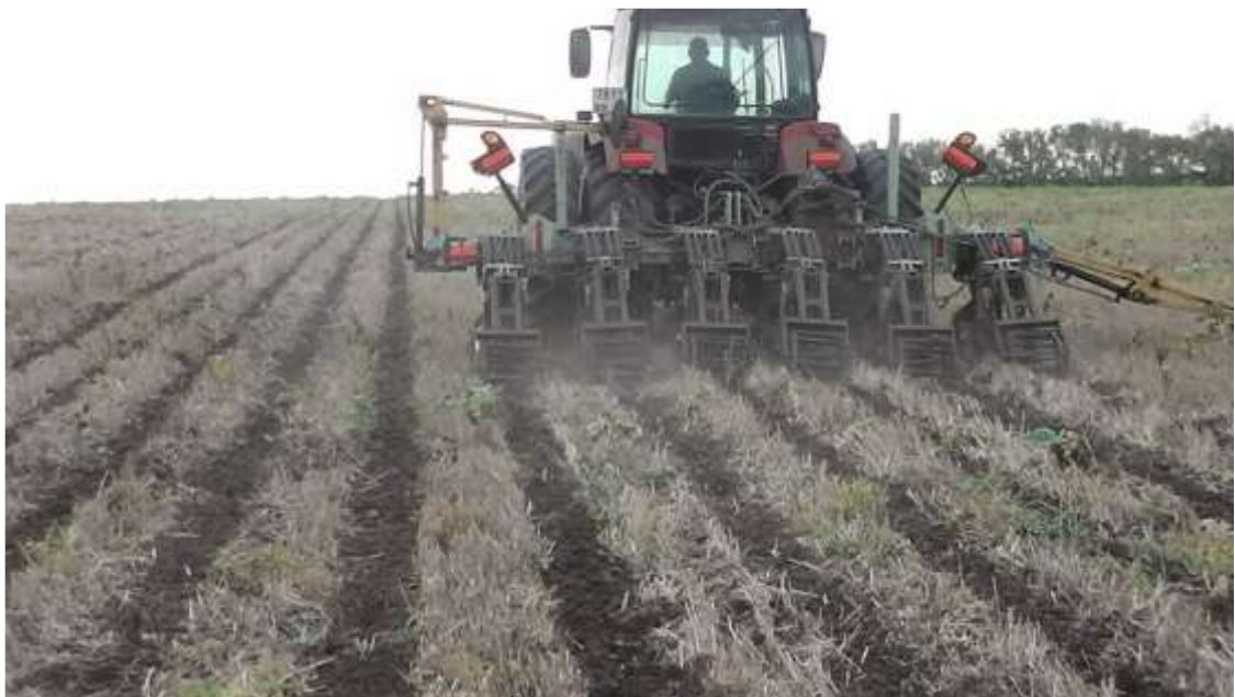
Рис. 1. Нарізка смуг МТЗ-1523 + культиватор Ортман
