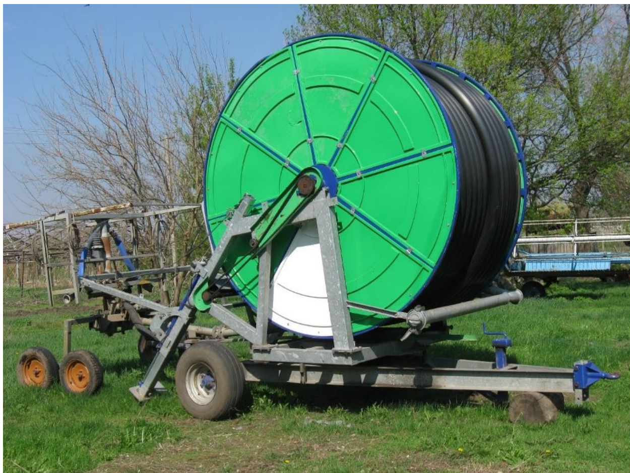
Рис. 3.2.2 Установка дощування ІРТЕС 100-350
