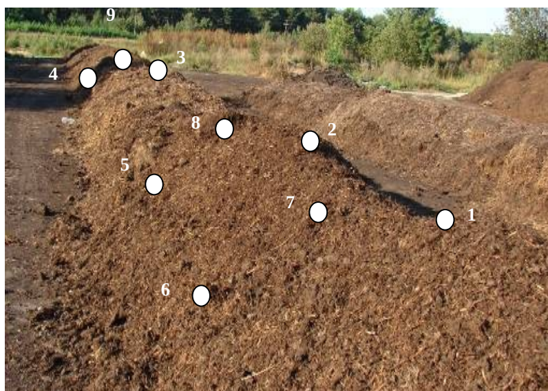
Рис. 4.5.1 – Загальний вигляд буртів і схема точок вимірювання температури
