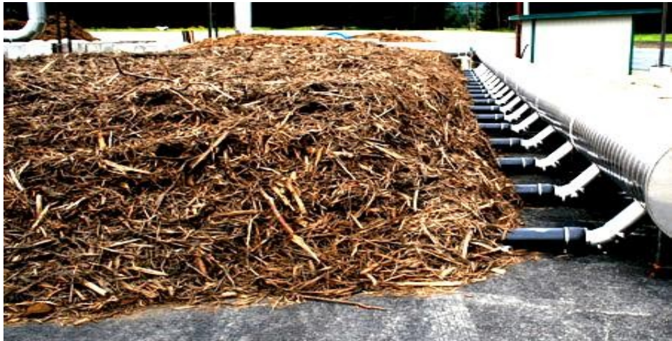
Рис. 4.7.3 - Біофільтр в системах компостування з примусовою відсмоктувальною аерацією
