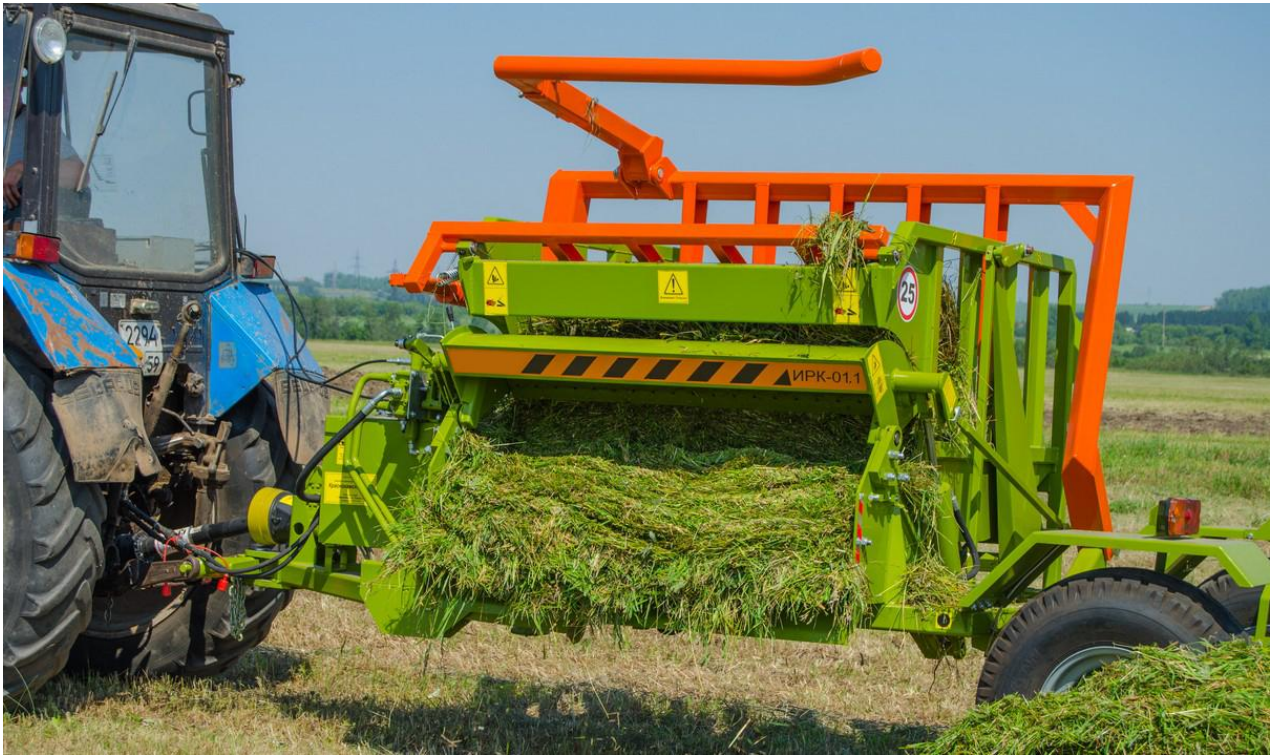
Рисунок 1.3 – Подрібнювач рулонів – кормороздавач ПРК-01
