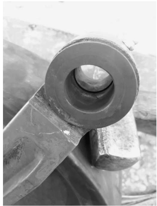
Рисунок 3.4 – Втулки підшипників ковзання лап посівного комплексу «John Deere 1780» після роботи впродовж 2 років (а) з аналогу (УПА 6-30) та (б) розробленого ПКМ
