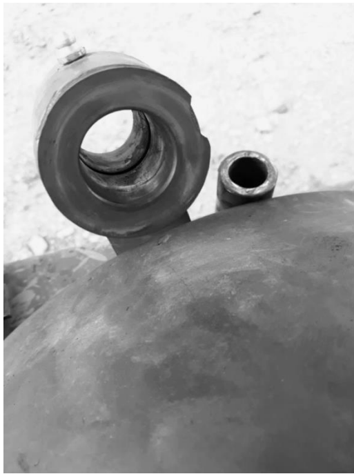
Рисунок 3.4 – Втулки підшипників ковзання лап посівного комплексу «John Deere 1780» після роботи впродовж 2 років (а) з аналогу (УПА 6-30) та (б) розробленого ПКМ
