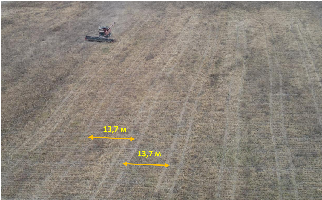
Рис.3.4. Комбайн Case IH 9240 на експериментальному полі. Ширина між суміжними проходами – 13,7 м.
