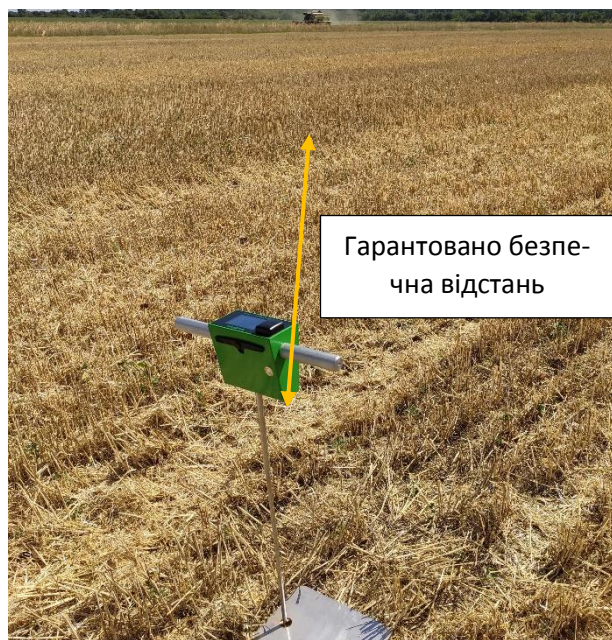
Рис.4.1. Працююча техніка повинна бути завжди у полі зору працівника, що вимірює твердість ґрунту.
