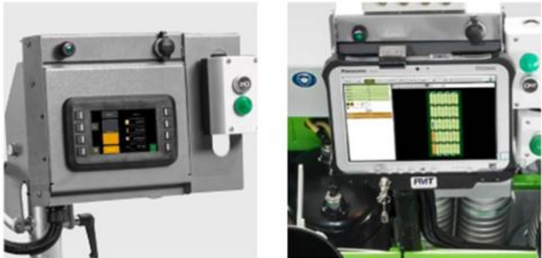
Рис. 1.8. Мехатронна система eMotion керування селекційною сівалкою Row Motion
