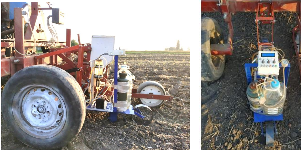
Рис. 3.2. Експериментальна гідросівалка з мехатронною системою контролю та керування роботи - інтервали між висіяним насінням см.
