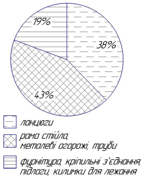
Рис. 1.1 – Розподілення відмов за вузлами та елементами стійлового обладнання
