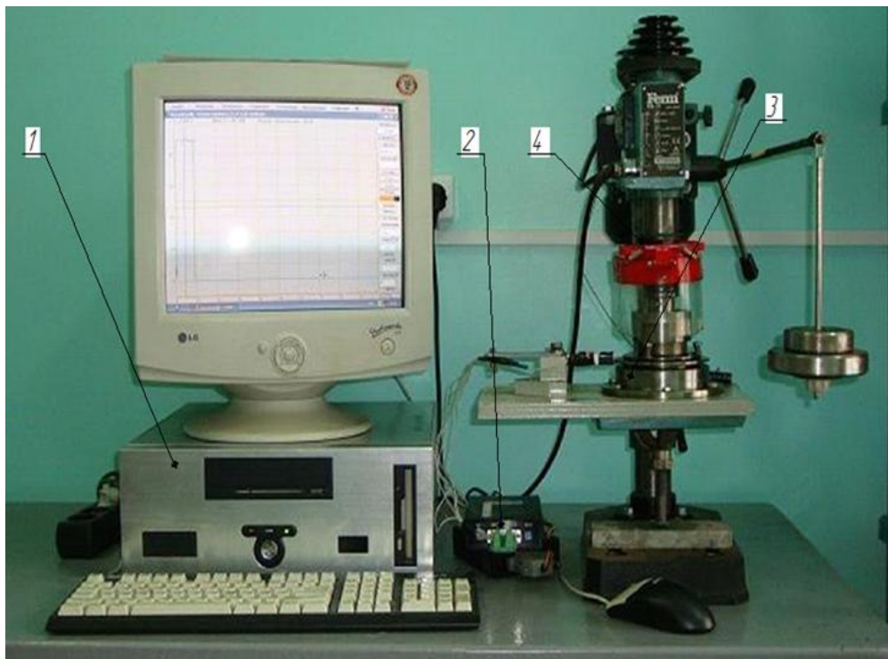
Рис. 3.4 – Загальний вигляд універсальної машини тертя МТУ- 01: 1 – ПК; 2 – попередній підсилювач і модуль АЦП; 3 – тензодатчик; 4 – з'єднання, що випробовується
