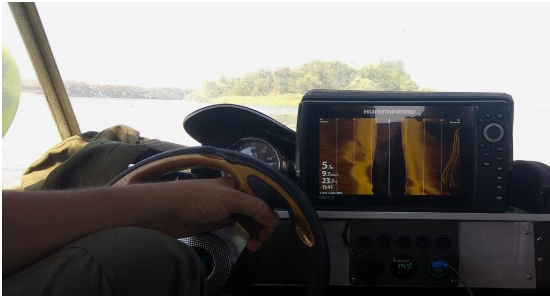
Рис. 2.2. Сучасний ехолот Humminbird HELIX 9 (структур-сканер) для точного аналізу структури дна
