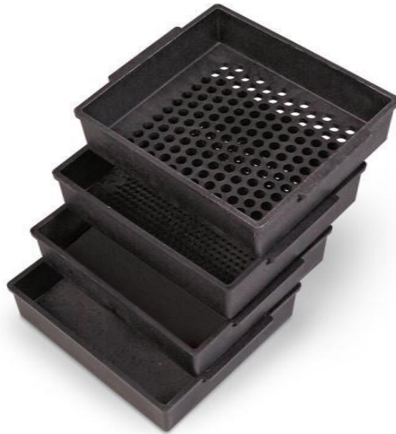
Рисунок 6. Пенсільванський сепаратор кормів
