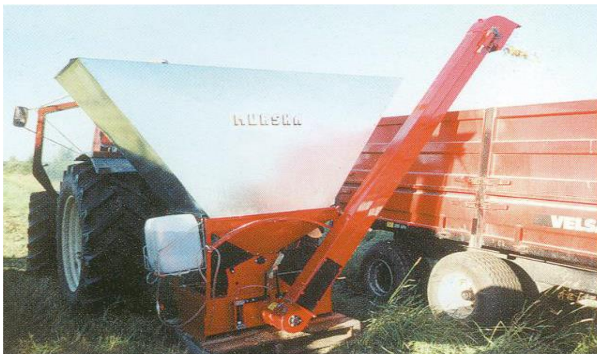
Рисунок 3. Процес консервації зерна кукурудзи в АФ «Чумаки» вальцьовим млином Murska
