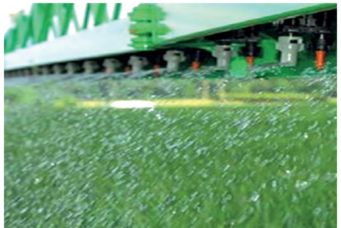
Рис. 2. Крупнокрапельне внесення рідких мінеральних добрив при проведенні прикореневого підживлення озимих зернових культур рано навесні
