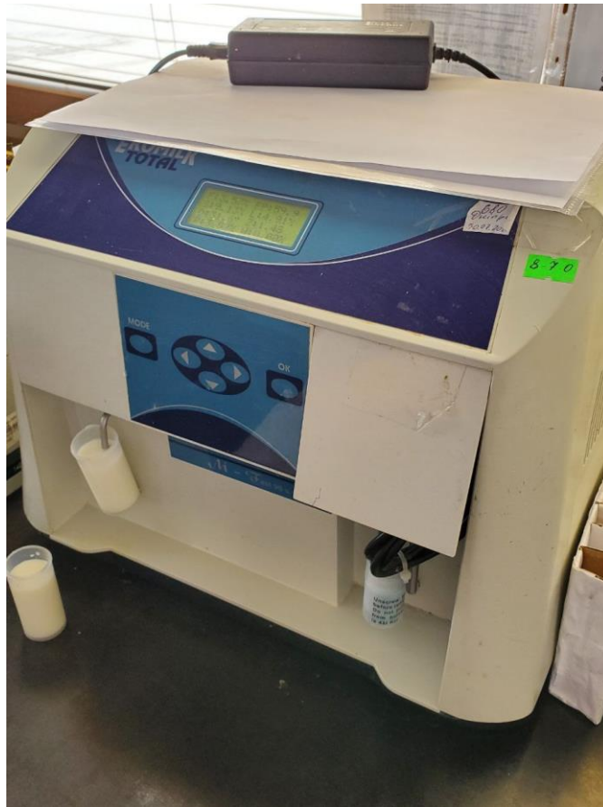
Фото 2.2.2. Дослідження молока за допомогою аналізатора молока ЕКОМІЛК
