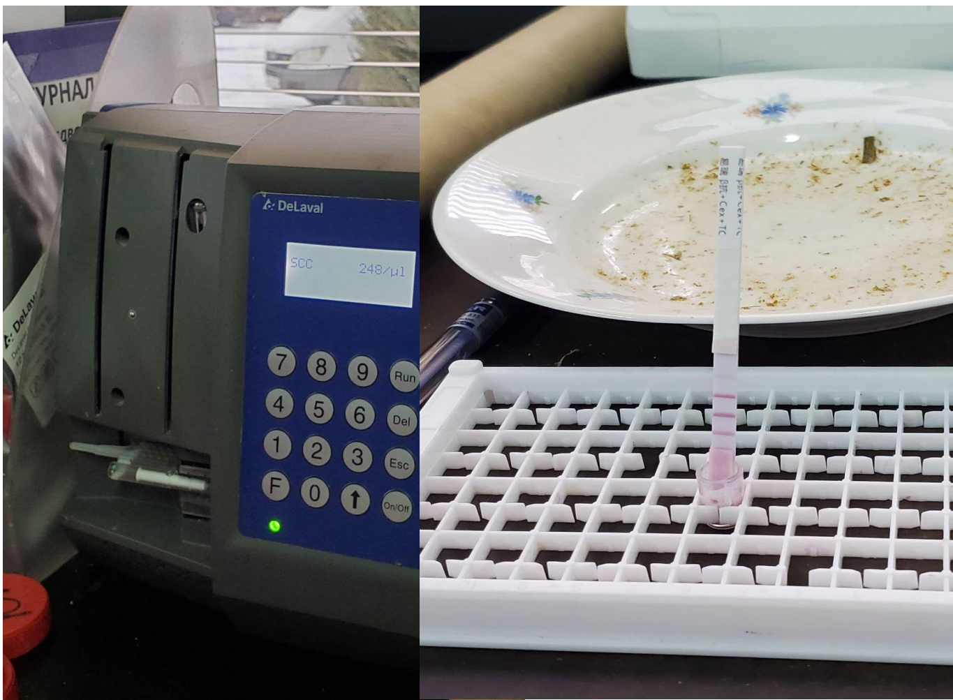
Фото 2. Аналізатор молока для виявлення в ньому соматичних клітин та тест смужка на наявність в молоці антибіотиків
