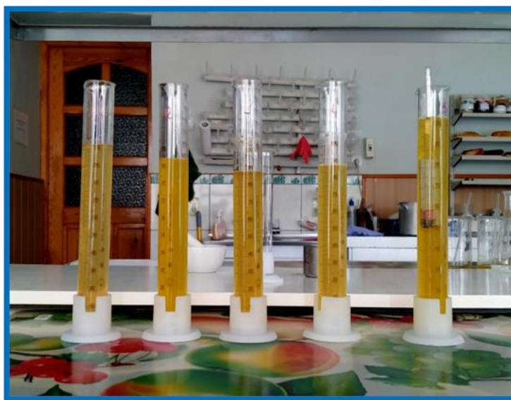
Рис. 2. Визначення вмісту води в меді за допомогою ареометра.
