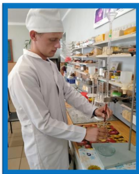
Рис. 4. Титрування 10% розчину меду 0,1 Н розчином NaOH.
