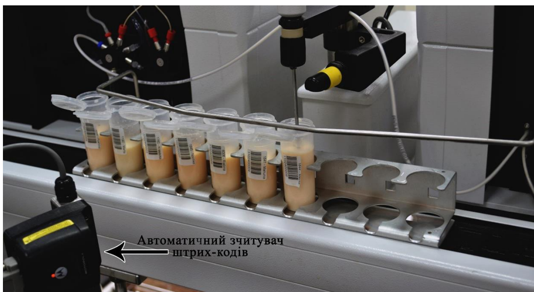
Рис. 9. Аналіз зразків молока за допомогою автоматичного приладу «DairySpec & SomaCount Combi»
