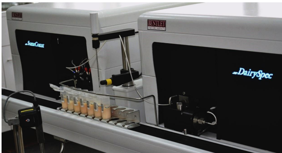
Рис. 1. Комбінований аналізатор молока «DairySpec & SomaCount Combi»
