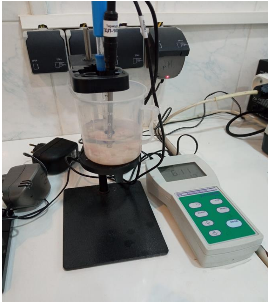
Рис.7. Визначення рН м'яса кролів за допомогою рН-метру
