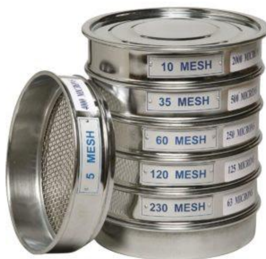
Рисунок 3.2 – Набір решіт використовуваних при ситовому аналізі
